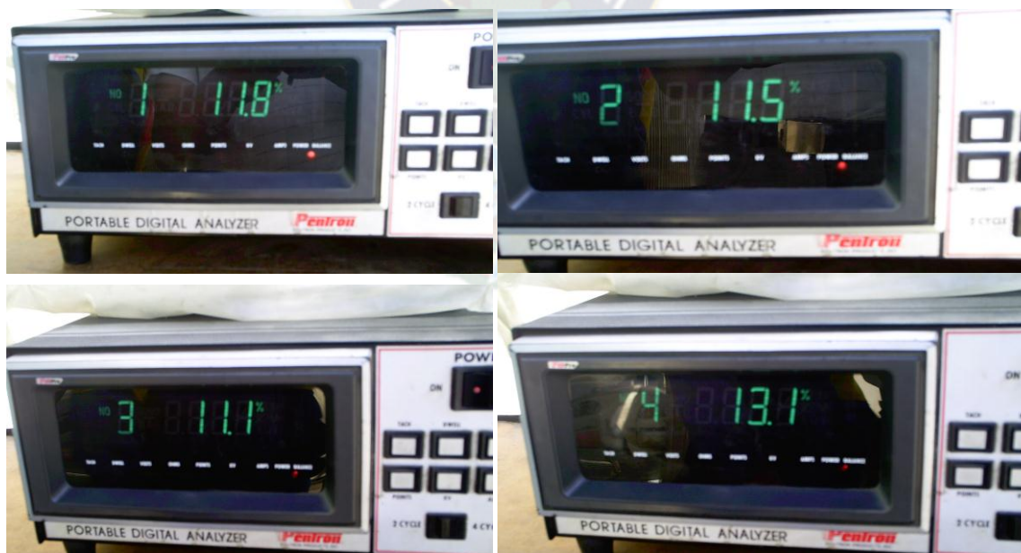
Figura 4.15 Mediciones de los rendimientos de cada cilindro (sistema de encendido sin asistencia electrónica)
