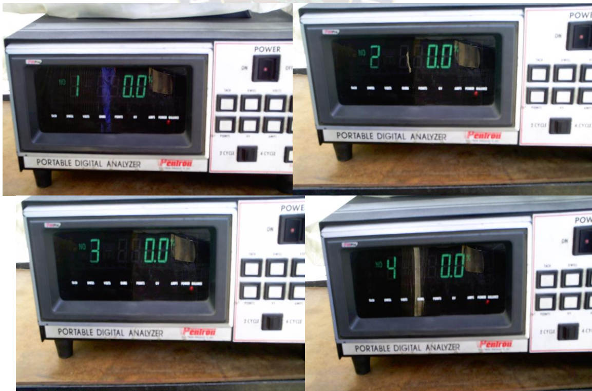
Figura 4.19 Mediciones de los rendimientos de cada cilindro (sistema de encendido con bobina seca y asistencia electrónica)
