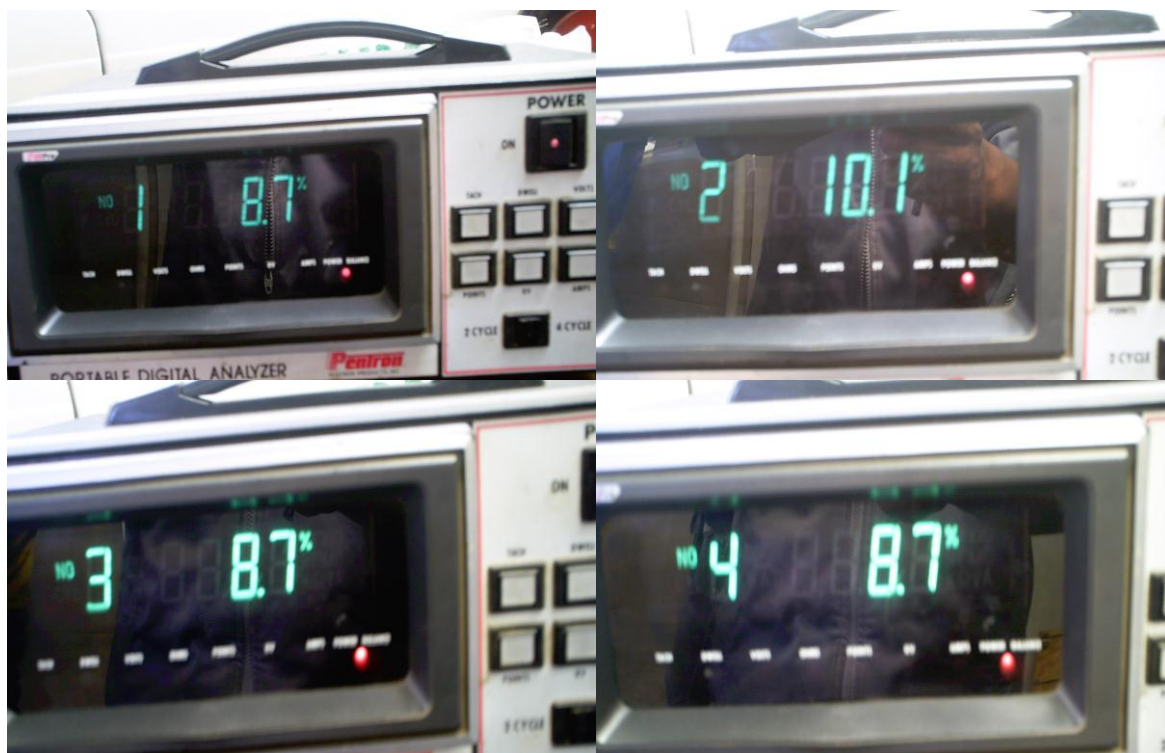
Figura 4.17 Mediciones de los rendimientos de cada cilindro (sistema de encendido con asistencia electrónica)
