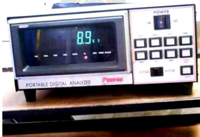
Figura 4.18 Voltaje en las bujías (sistema de encendido con asistencia electrónica)
