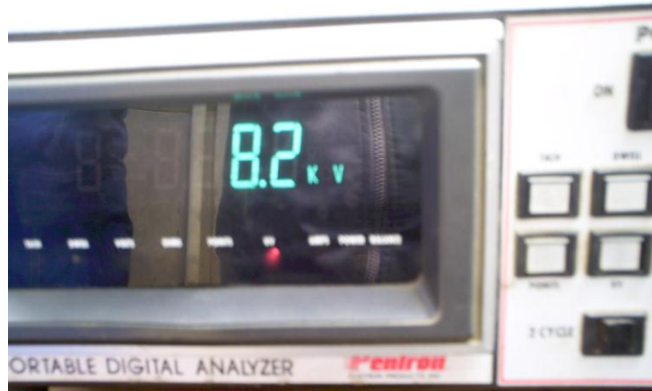
Figura 4.16 Voltaje en las bujías (sistema de encendido sin asistencia electrónica)
