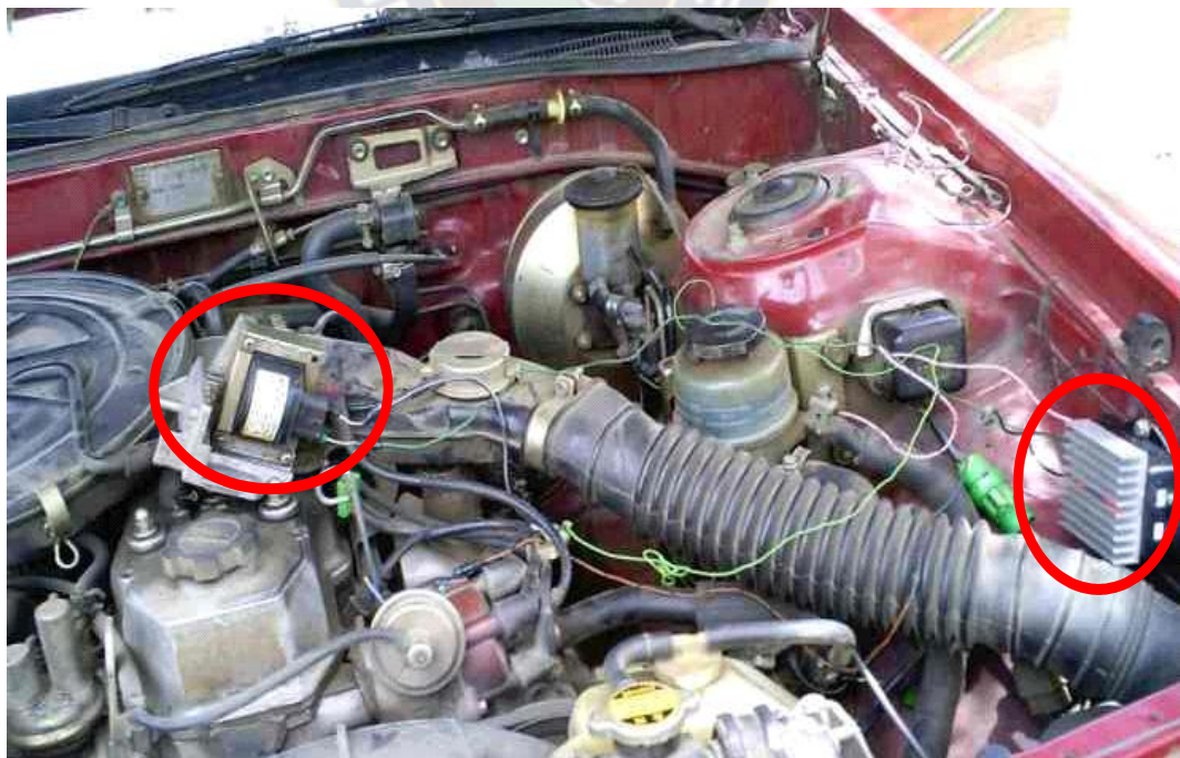
Figura 4.21 Puesta en marcha del motor con la bobina seca y el módulo electrónico
