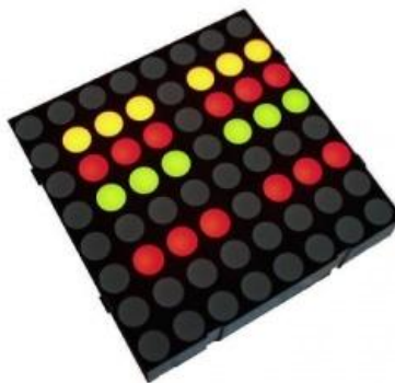
Gráfico 4.- Matriz de LEDs RGB de 8x8 puntos (www.ucontrol.com.ar).
