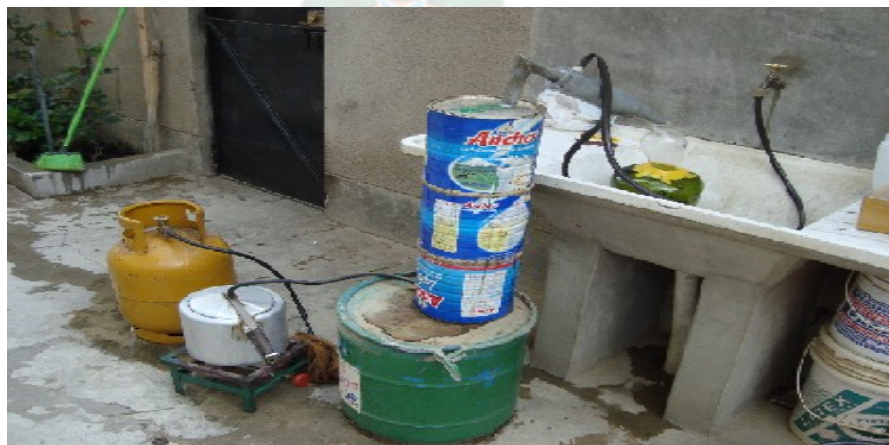
Figura 6: Destilador por arrastre de vapor artesanal o casero
