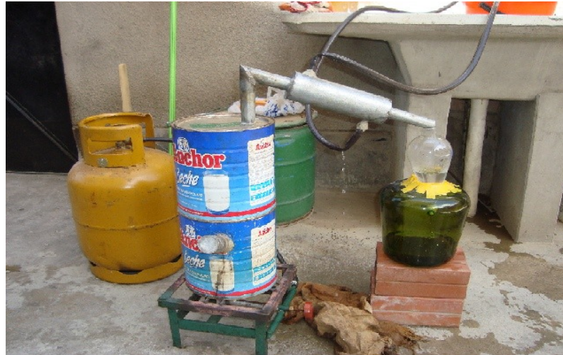
Figura 5: Destilador con agua artesanal o casero
