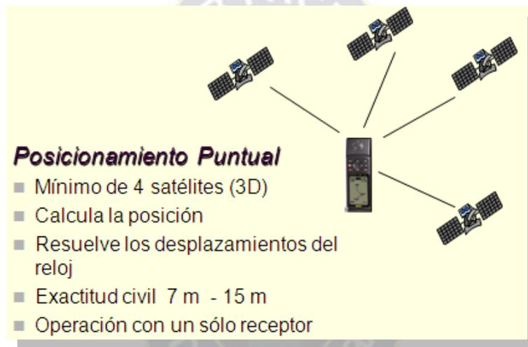
**Figura II-26** Posicionamiento Puntual
