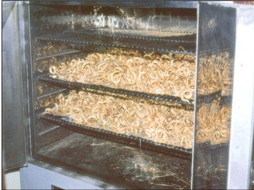
Foto 17. Horno a GLP para el secado del algarrobo
