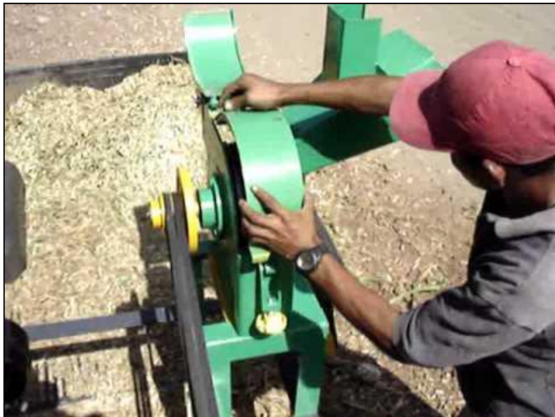
Foto 16. Molino de martillo utilizado para la trituración de algarrobo
