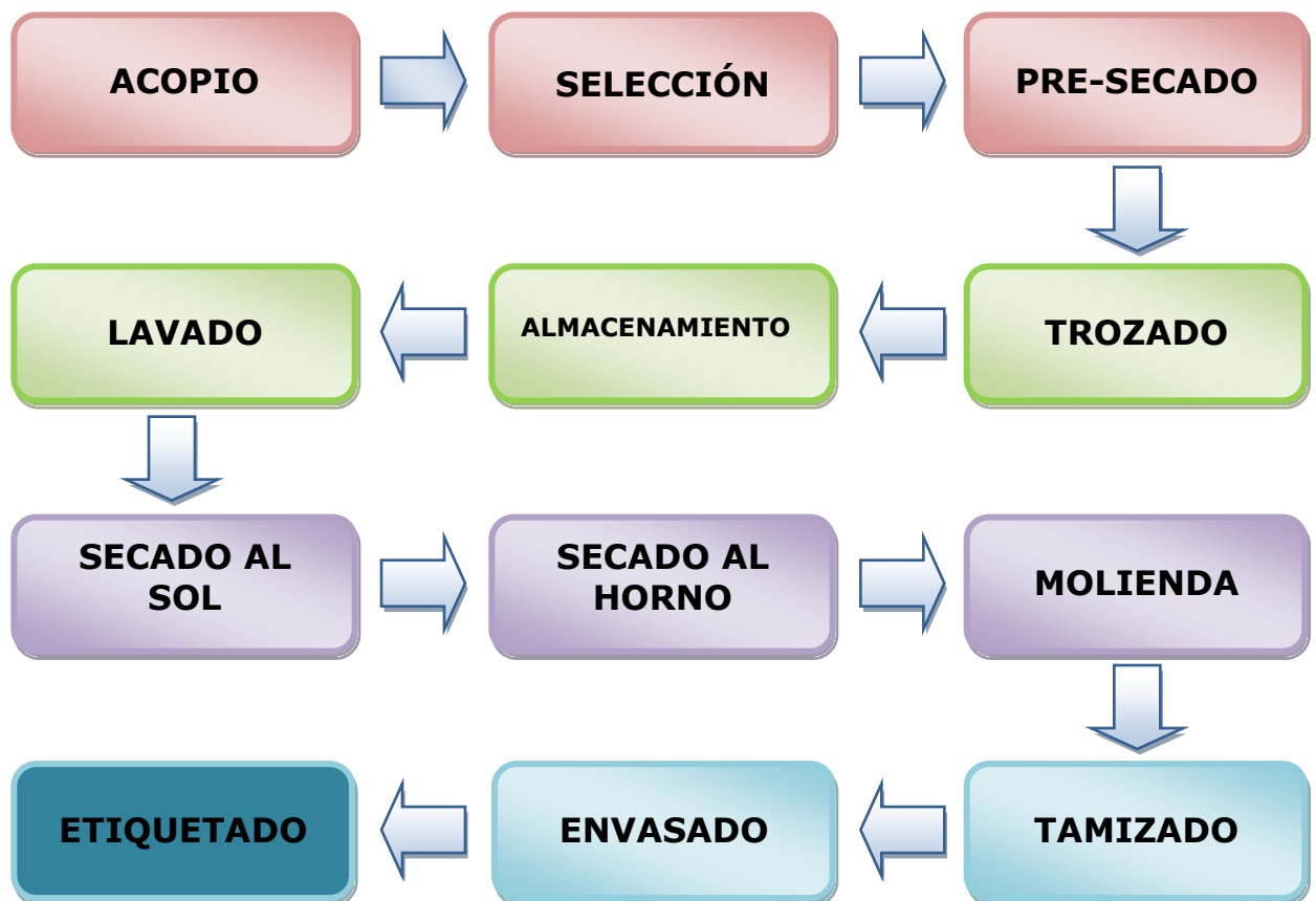
Figura 15. Descripción del proceso en la elaboración de harina
