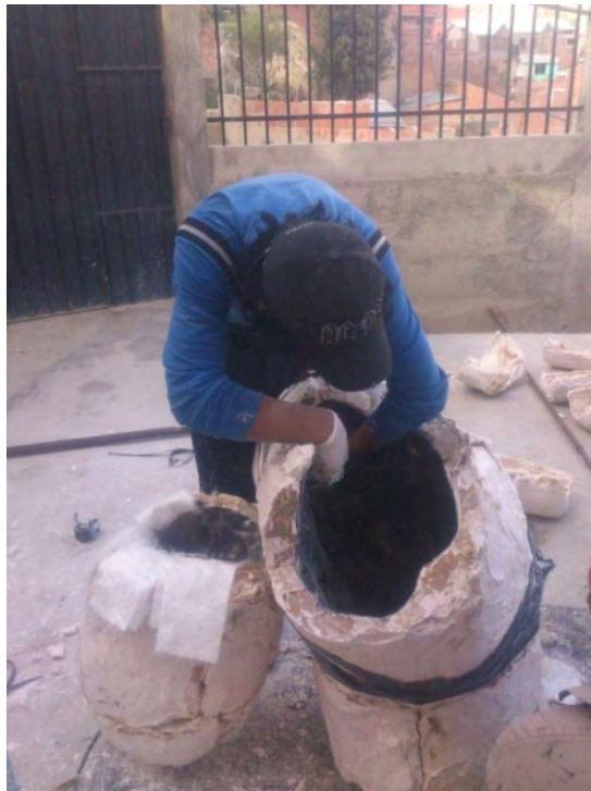
FOTO 21. Colocando tiras de fibra de vidrio para unir los moldes
