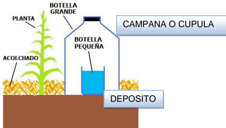
Ilustración 3 Instalación del komkom (fabricación del kondenskompressor, 2010)
