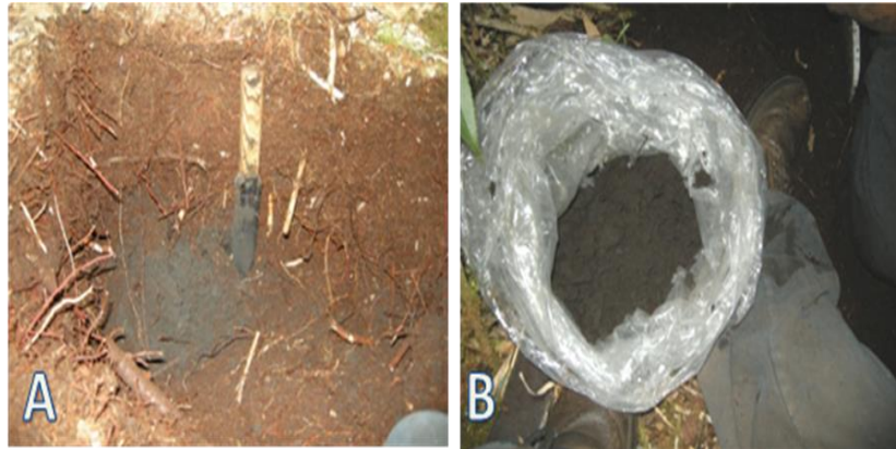
Fotografía 9. A Retiro de la capa orgánica. B extracción de la muestra de suelo
