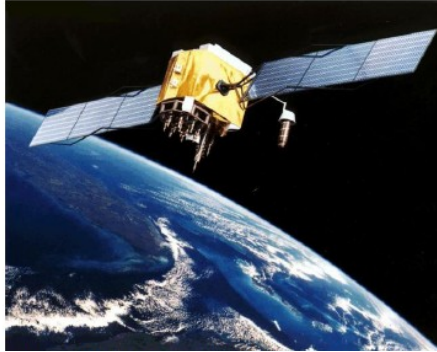
Figura 5. Satélite del segmento espacial del Sistema de Posicionamiento Global (GPS)
