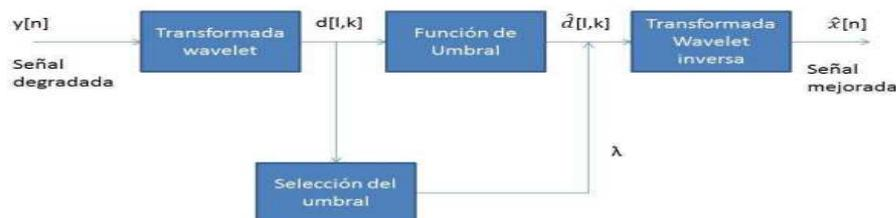
**Figura 2.8:** Esquema de reducción de ruido Caracterización.
