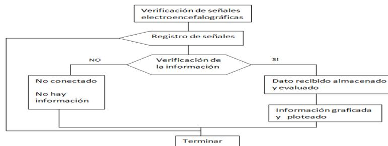
**Figura 3.25:** Algoritmo de adquisición de datos
