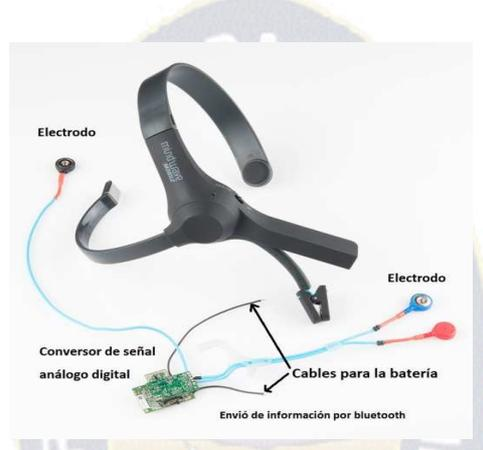
**Figura 3.8:** Dispositivo por partes neurosky
