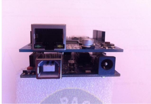
Figura 3. 3 Montaje de la Placa Arduino y Shield Ethernet
