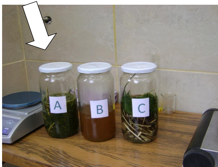
Figura26. Obtención de mayores concentraciones de biocida con la técnica de extracción A (maceración).
