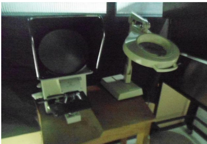
Figura 10. Laboratorio INIAF, Microscopio de Proyección o lanámetro
