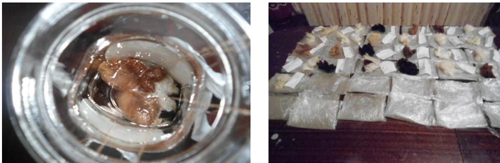
Figura 11. Lavado con alcohol etílico y secado de las muestras para observación de las fibras
