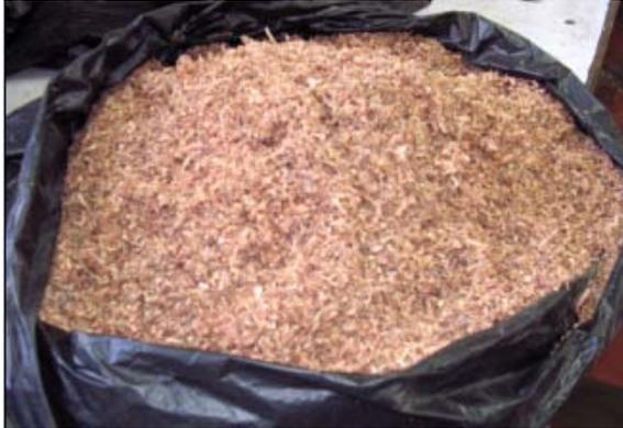
**Impregnación con ácido sulfúrico**
