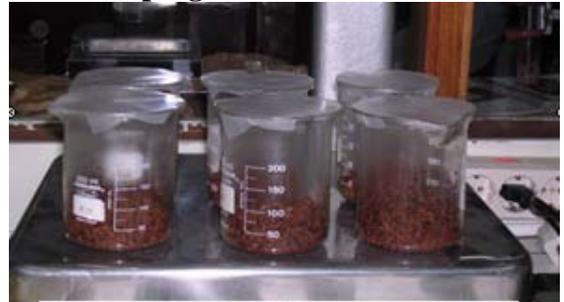
**Filtrados de hidrolizados fracción líquida**
