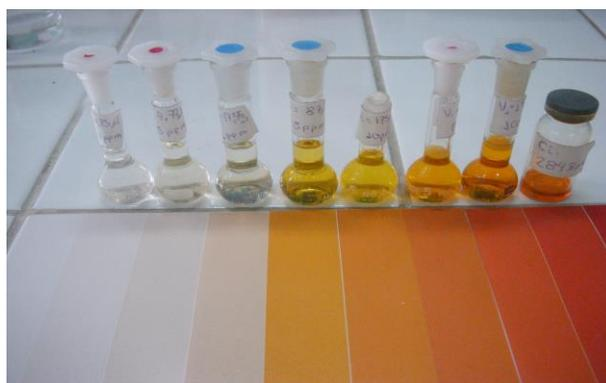
Como último paso de laboratorio se llevaron las muestras al espectrofotómetro para verificar si las coloraciones correspondían a algún caroteno, al respecto Martínez (2003) afirma que el espectro visible de los carotenoides es bastante característico en el rango de 400 a 500 nm. Se pudo observar un máximo alrededor de 450 nm y generalmente se aprecian dos máximos u hombros a cada lado. (Anexo 10).
