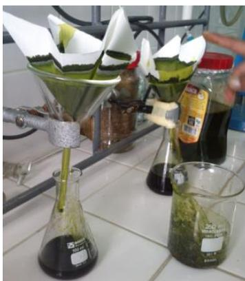
Luego se dejó secar la muestra concentrada en la estufa a 45°C por aproximadamente 15 días. Paralelamente se tomó una pequeña muestra y se la diluyó en diclorometano con esta muestra se corrió una placa de cromatografía en
