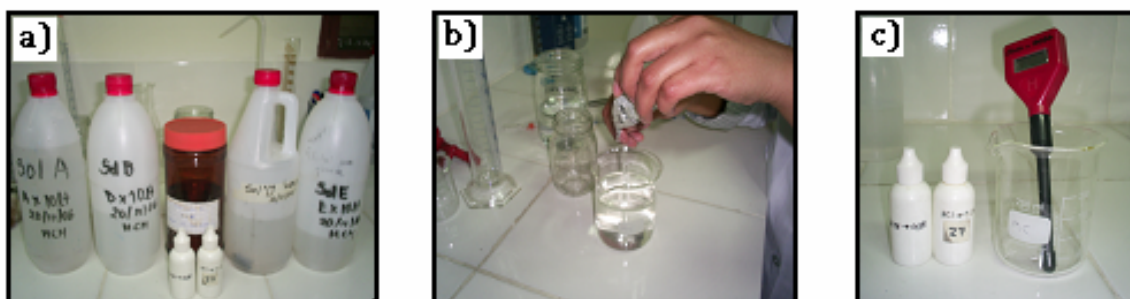
Fig. 3 a) Soluciones stock MS; b) Adición de sacarosa al medio MS; c) Ajuste de pH.
