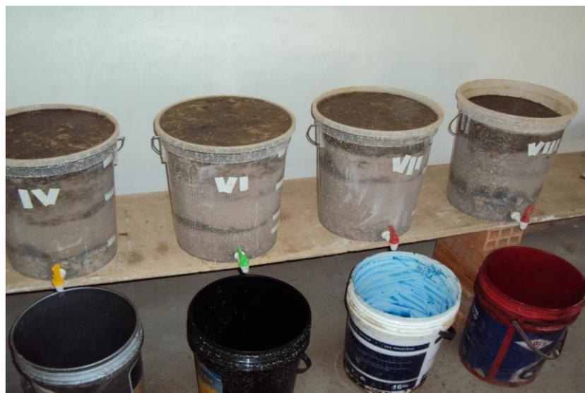
**Fotografía 5:** Primera carga de agua (5 litros/balde) de la segunda serie de ensayos.
