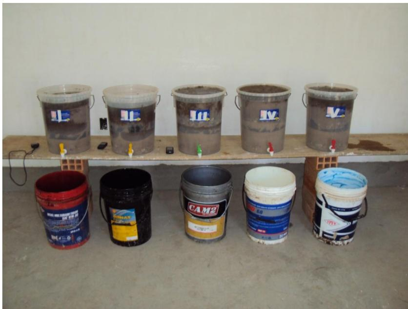
**Fotografía 3:** Primera carga de agua (10 litros/balde) de la primera serie.
