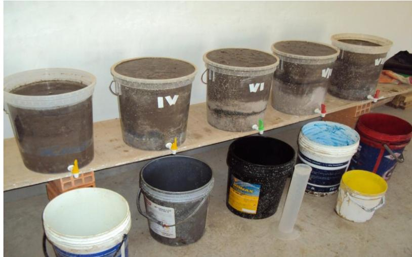
**Fotografía 6:** Segunda carga de agua (10 litros/balde) de la segunda serie con el ensayo (I) de testigo.
