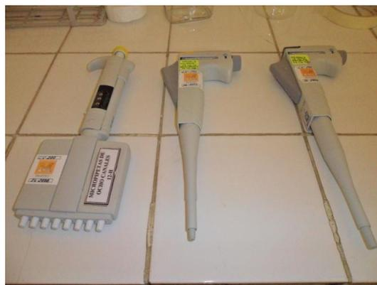
Micropipetas de 20  $\mu$ l a 1000  $\mu$ l
