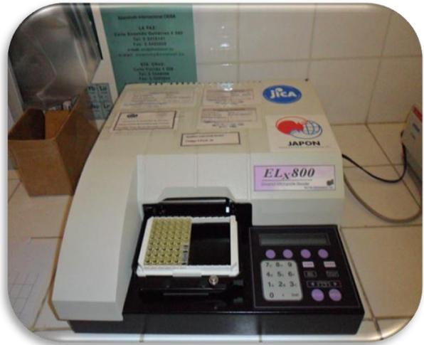
**Figura N° 27. Lectura de las muestras en el espectrofotómetro a 450nm.**
