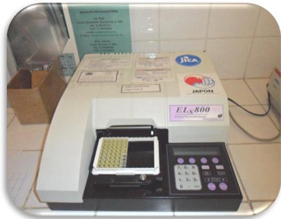
**Figura N° 18. Lectura de las muestras en el espectrofotómetro a 450nm.**
