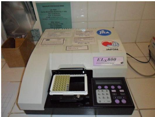
Espectrofotómetro de microplaca 450 nm
