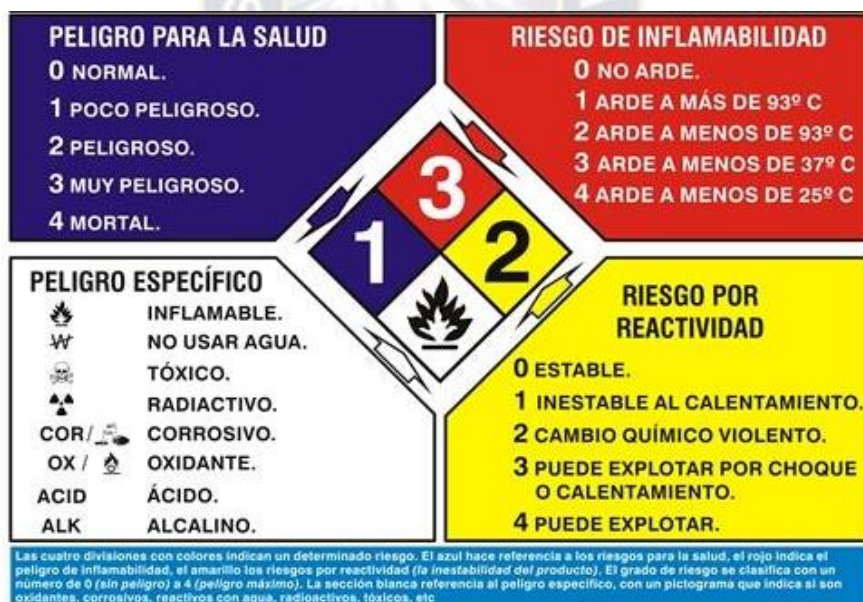
Figura 2.30. Diamante de Identificación de riesgos
