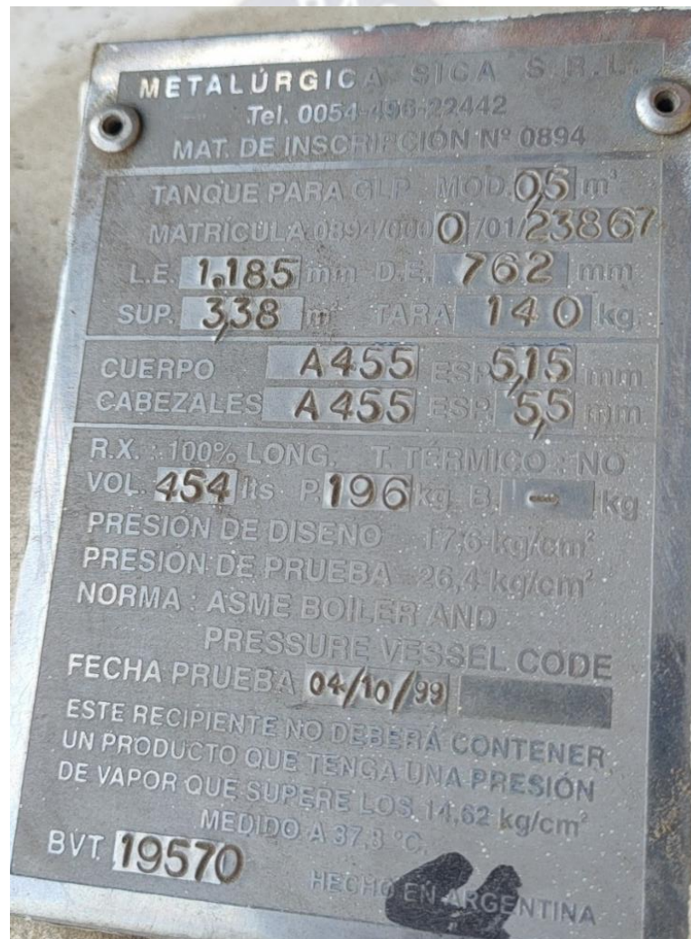
Figura 2.16 Placa de Identificación de un Tanque de 0,5 M3
