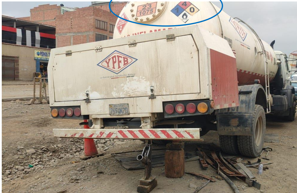
Figura 5.6. Ubicación de señalización de seguridad del camión cisterna de la unidad
