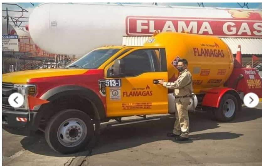
Figura 5.7. Representación de una cisterna de menor capacidad para la distribución de GLP a clientes residenciales
