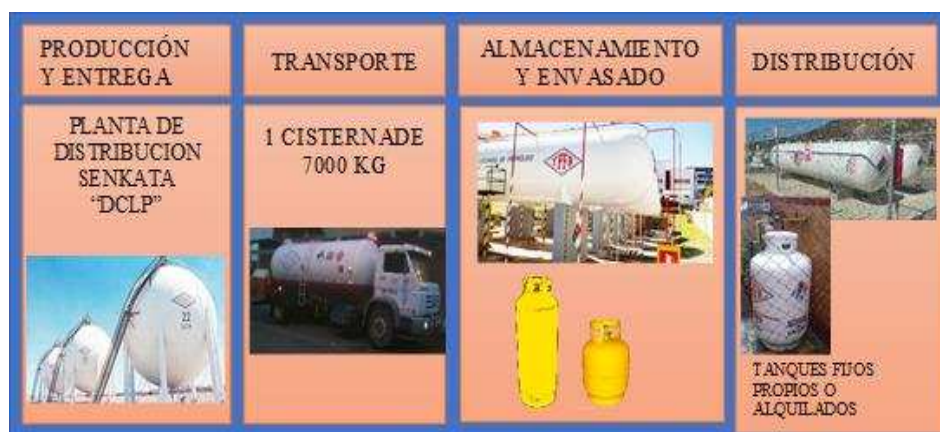
Figura 2.9 Distribución de GLP a granel
