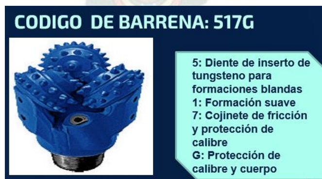
Figura 2.35. Ejemplo de designación de trépano
