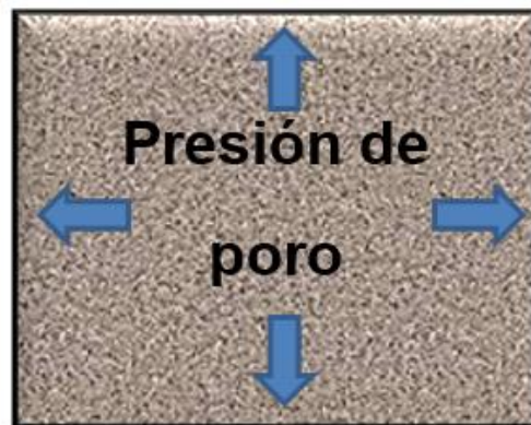
Figura 2.2. Representación de la Presión de Formación
