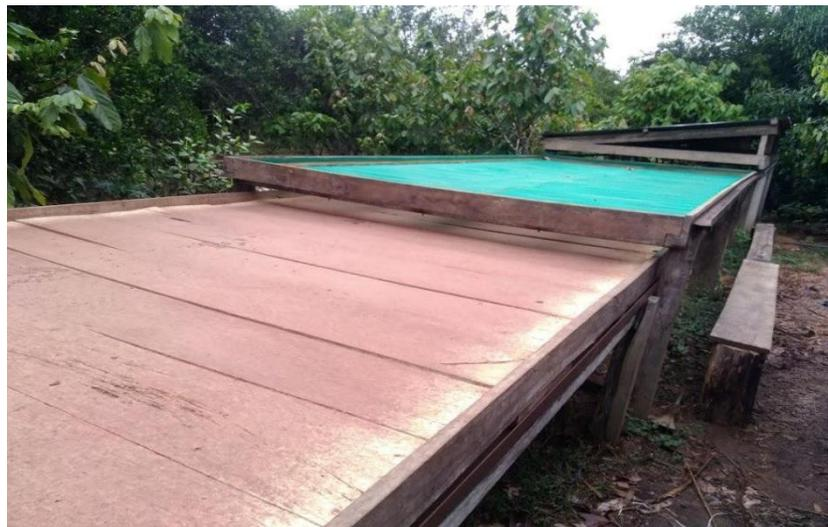
Figura 98 . Secadora de madera con malla diamante. Fuente: PIAF – EL CEIBO
