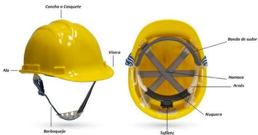
FIGURA 7 PARTES DE UN CASCO
