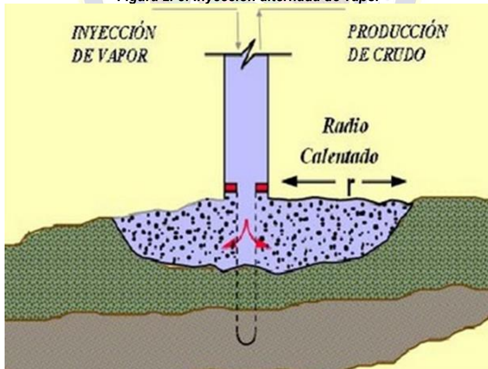
Figura 2. 8: Inyección alternada de vapor
