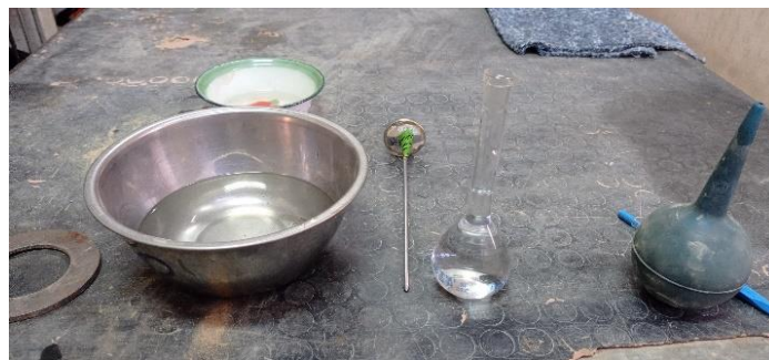
Figura 41 Proceso de colocado de agua y suelo al picnómetro
