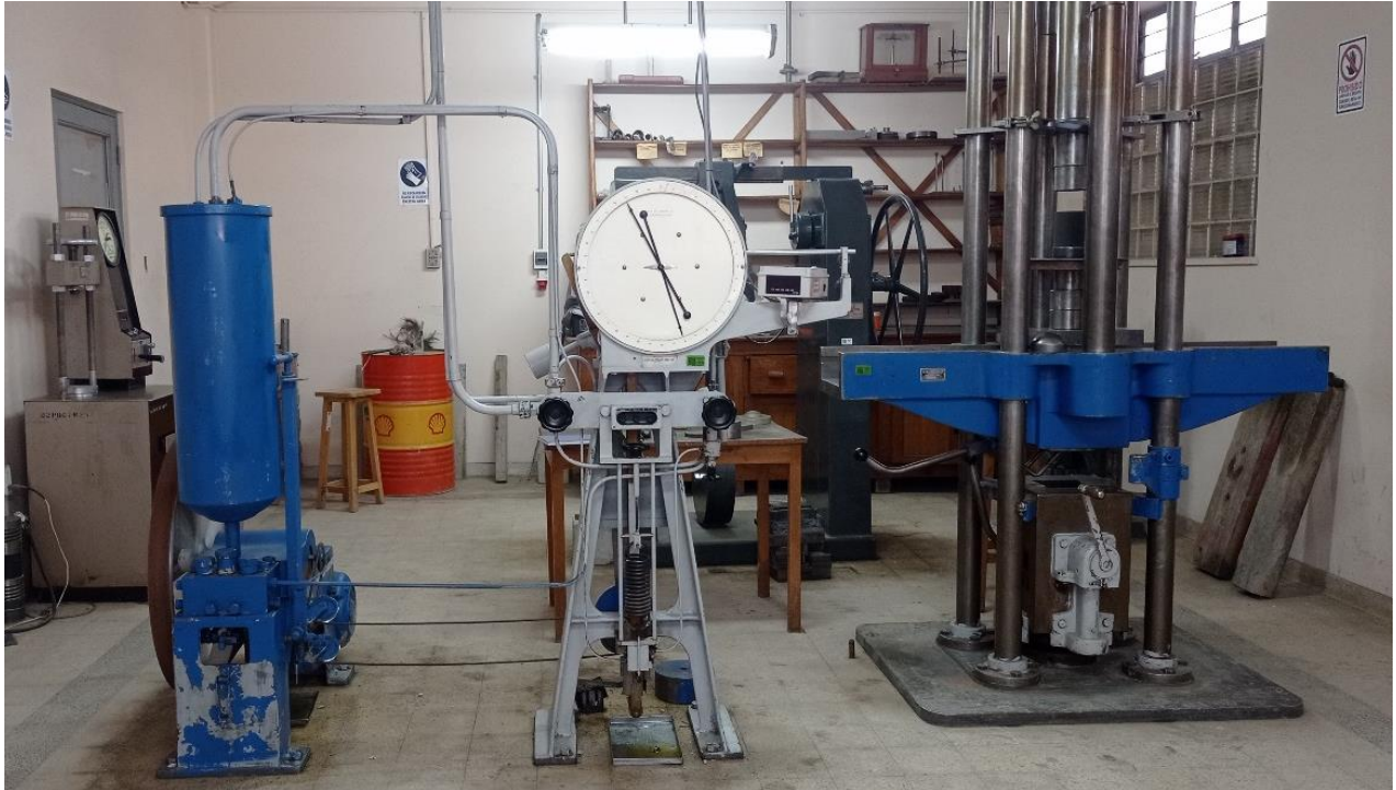
Figura 23 Prensa (Ruptura de las probetas)
