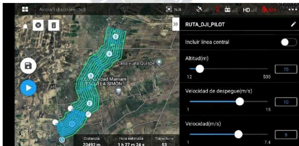
Figura 26. Trayectoria del plan de vuelo ejecutado por segmento
