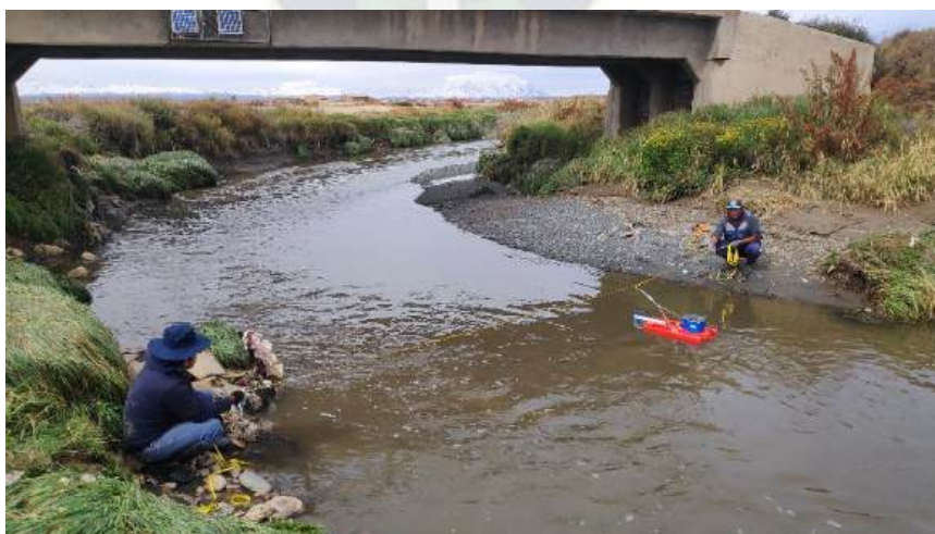
Fotografía 11. Medición del caudal con ADCP en la sección de aforo
