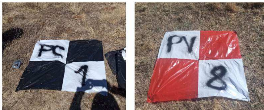
Fotografía 6. Dianas de marcadores de los puntos de control y validación
