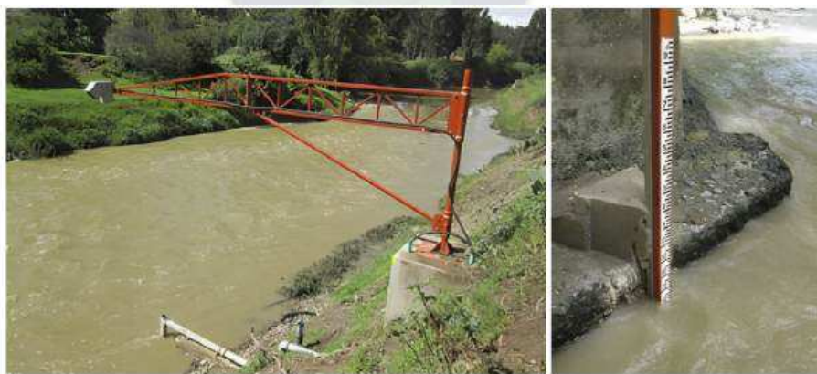
Figura 15. Estación hidrométrica automática y regla limnométrica Fuente: Fotografía extraída de la página web de la Corporación Autónoma regional de Boyacá (2018).
