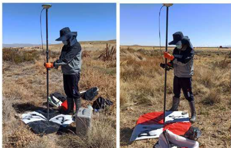
Fotografía 7. Medición de las coordenadas de los GCPs y validación
