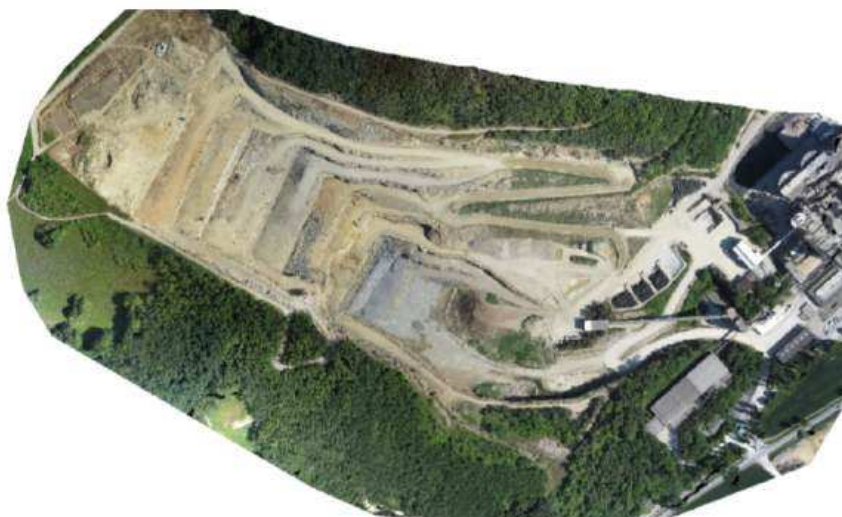
Figura 10. Ortofoto u ortomosaico georreferenciado Fuente: Imagen extraída de la página web de Pix4D Mapper.
