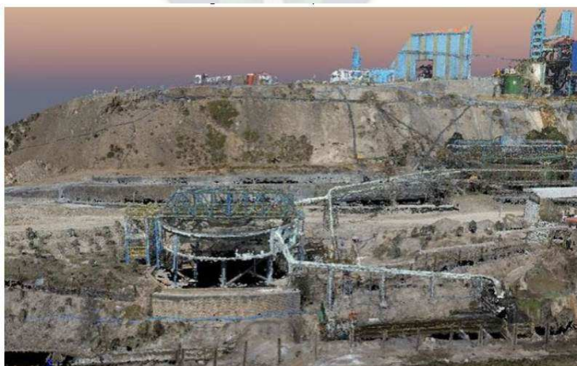
Figura 11. Nube de puntos densa Fuente: Imagen extraída de la página web de Pix4D Mapper.
