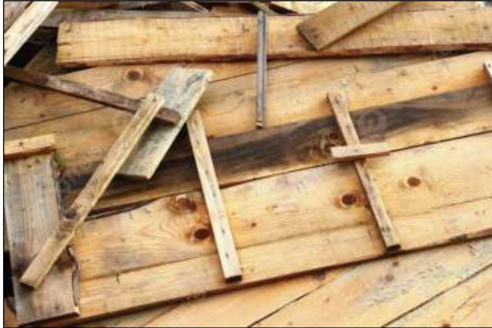
Figura No. 17 Encofrados de madera ya usados.
