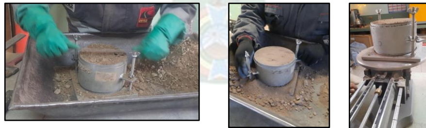
Figura 55. Moldeo y Pesaje de los moldes Fuente: Elaboración propia
