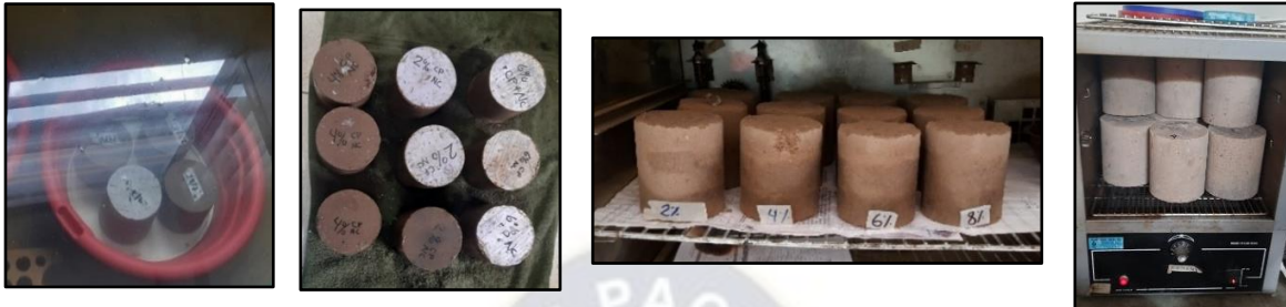
Figura 66. Curado y Secado de cilindros (Combinación de Suelo Reciclado y Cemento Portland)
