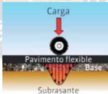
Figura 3. Distribución de cargas en un pavimento flexible Fuente: Ing. Martin Paucara Rojas, (2018), Manual de diseño y construcción de pavimentos de hormigón
