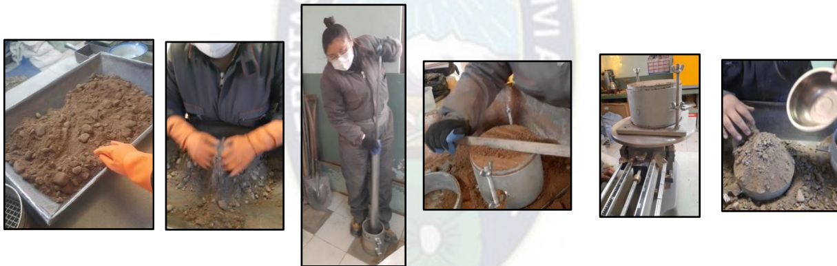
Figura 57. Ensayo Relación Humedad–Densidad (Combinación de Suelo Reciclado y Cemento Portland)
