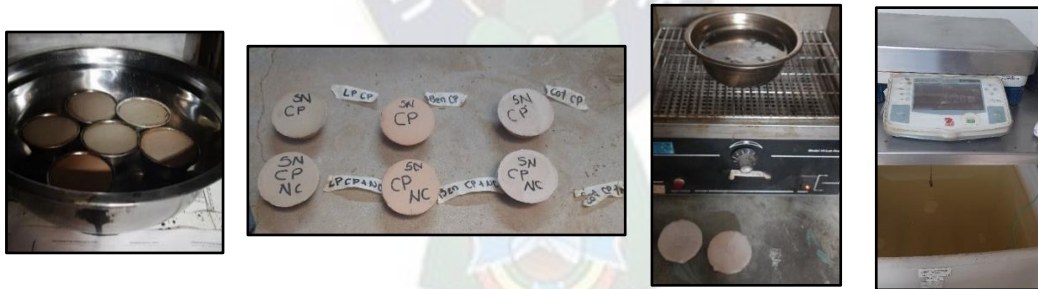
Figura 45. Límites de contracción y preparación con parafina Fuente: Elaboración propia
