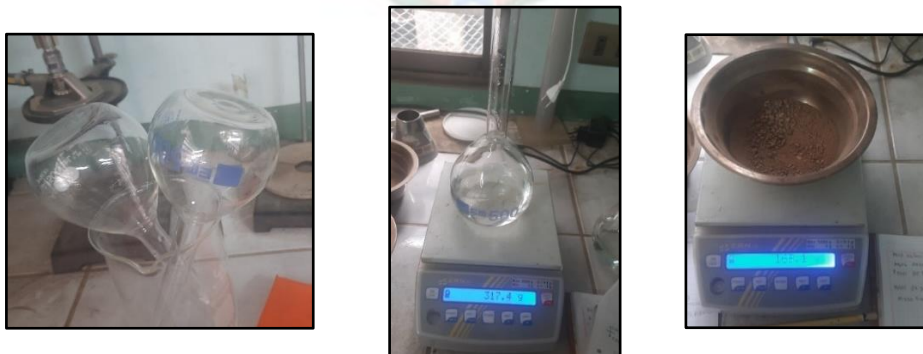
Figura 49. Calibración del Picnómetro y preparación de la muestra Fuente: Elaboración propia
