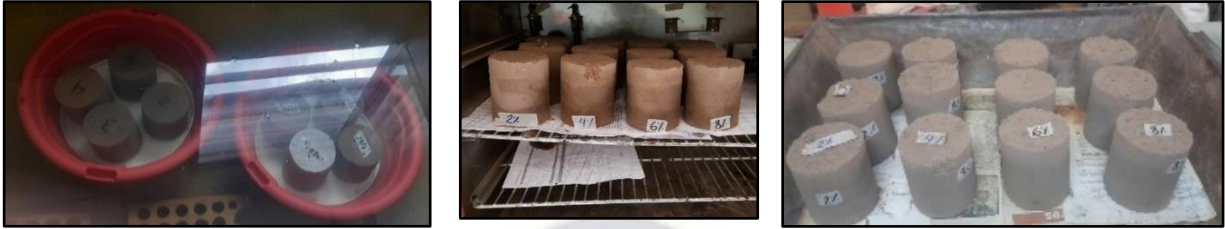
Figura 68. Curado y Secado de cilindros (Combinación de Suelo Reciclado, Cemento Portland y NovoCrete)
