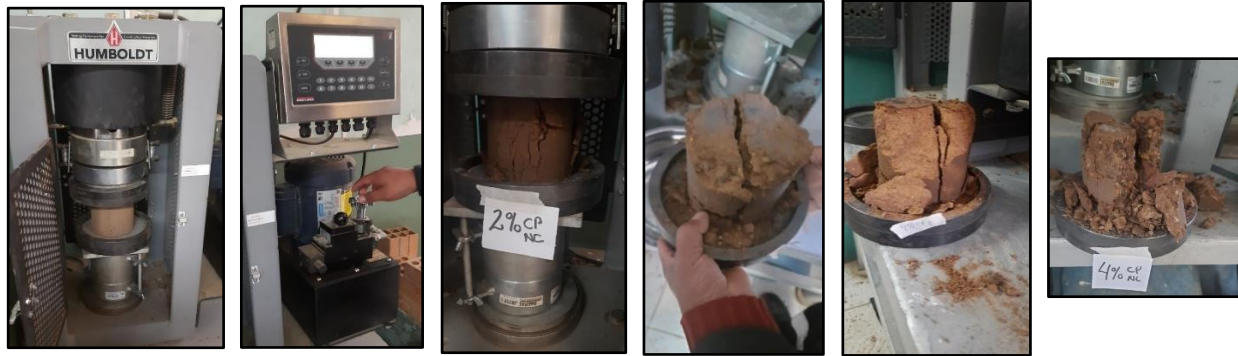
Figura 64. Rotura de cilindros (Combinación de Suelo Reciclado, Cemento Portland y aditivo NovoCrete)
