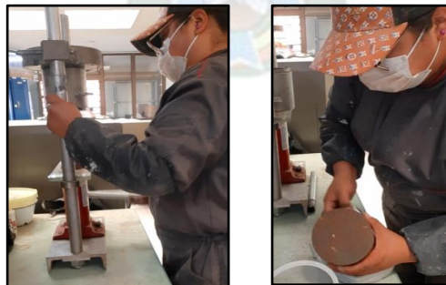
Figura 65. Preparación de cilindros (Combinación de Suelo Reciclado y Cemento Portland)
