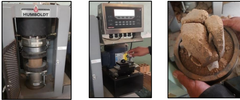
Figura 62. Rotura de cilindros (Combinación de Suelo Reciclado y Cemento Portland) Fuente: Elaboración propia
