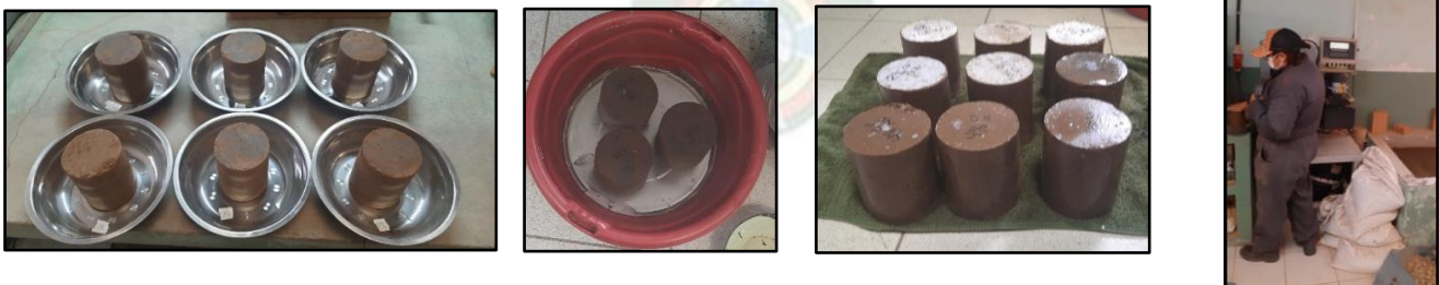
Figura 61. Curado de cilindros para la rotura (Combinación de Suelo Reciclado y Cemento Portland)
