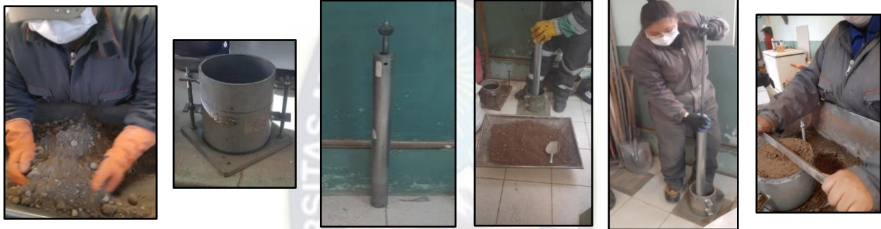
Figura 54. Preparación de la Muestra para el ensayo de Relación Humedad Densidad Fuente: Elaboración propia
