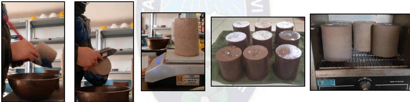
Figura 67. Cepillado de Cilindros para el Ensayo de Durabilidad (Combinación de Suelo Reciclado y Cemento Portland)
