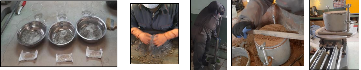
Figura 58. Ensayo Relación Humedad-Densidad (Combinación de Suelo Reciclado, Cemento Portland y aditivo NovoCrete)
