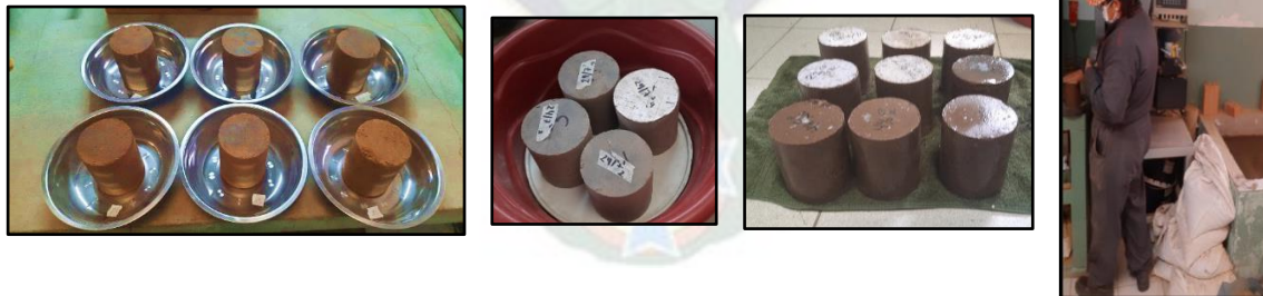
Figura 63. Curado de cilindros para la rotura (Combinación de Suelo Reciclado, Cemento Portland y aditivo NovoCrete) Fuente: Elaboración propia
