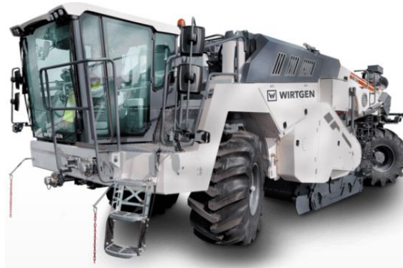
Figura 19. Recicladora Wirtgen WR 2500 S en frío y estabilizadora de suelos Fuente: (Noviembre de 2012), Wirtgen GmbH
