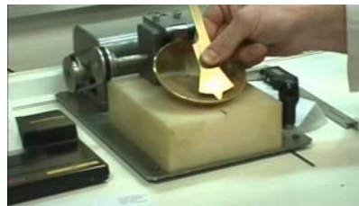
Figura 72. Corte con el ranurador Fuente: Geotecnia con Énfasis en Suelos
