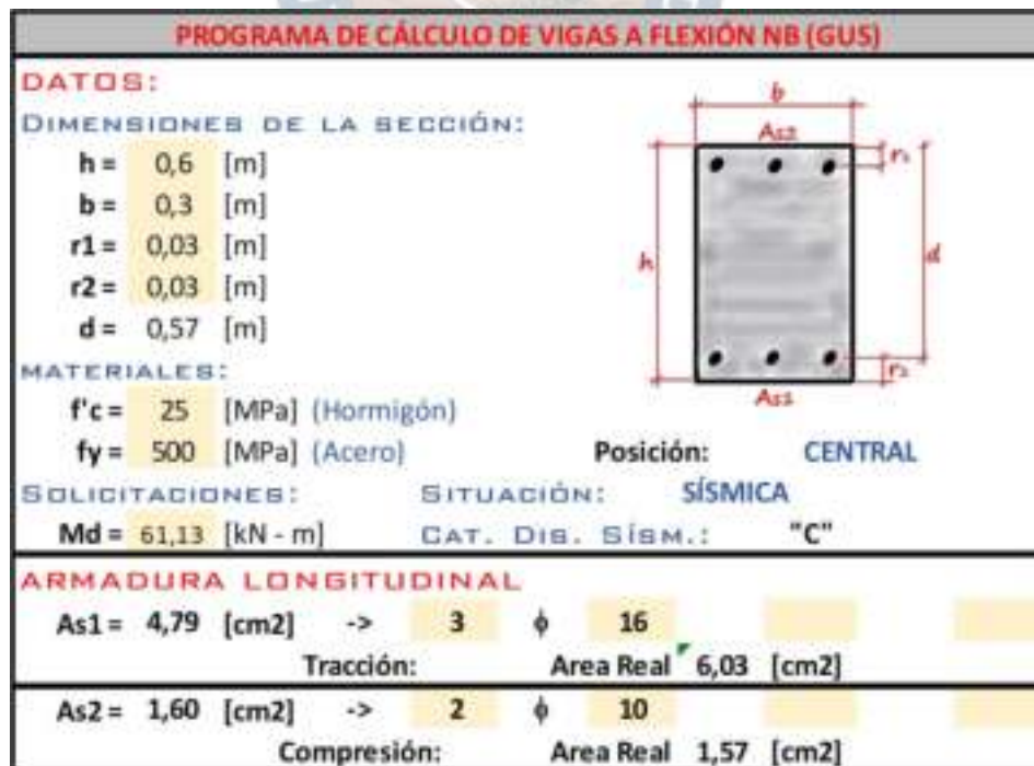
Figura 10.61. Resultados de la planilla de cálculo EXCEL a flexión (centro de la viga de estudio) s/ NB – 1225001 Fuente: Elaboración Propia
