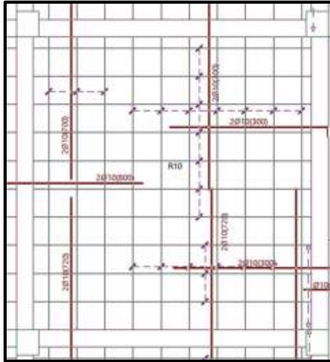
Figura 10.26. Esquema de armado longitudinal y transversal superior de la losa de estudio s/ CBH – 87 Fuente: Composición de Planos. Programa CYPECAD v2025.b
