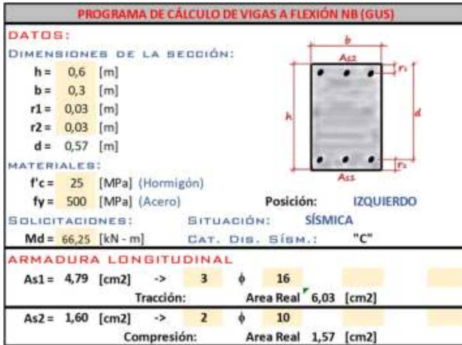
Figura 10.60. Resultados de cálculo EXCEL a flexión (lado izq. de la viga de estudio) s/ NB – 1225001 Fuente: Elaboración Propia
