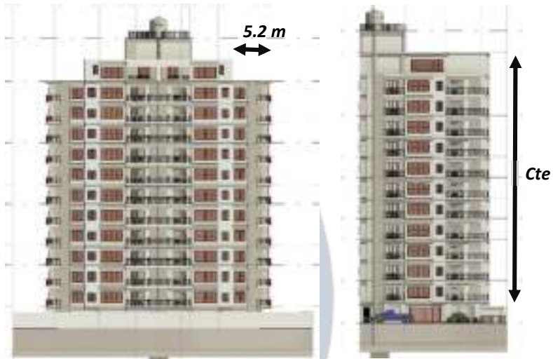
Figura 9.10. Verificación de Irregularidad Geométrica Fuente: Elaboración Propia
