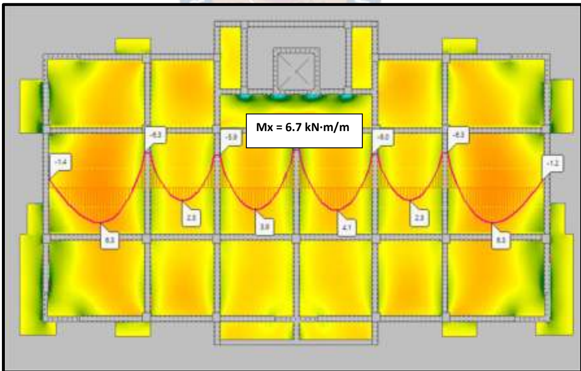
Figura 9.57. Representación en Piso Tipo de Momentos “Mx” por Isovalores según CBH - 87 Fuente: Isovalores. Programa CYPECAD v2025.b
