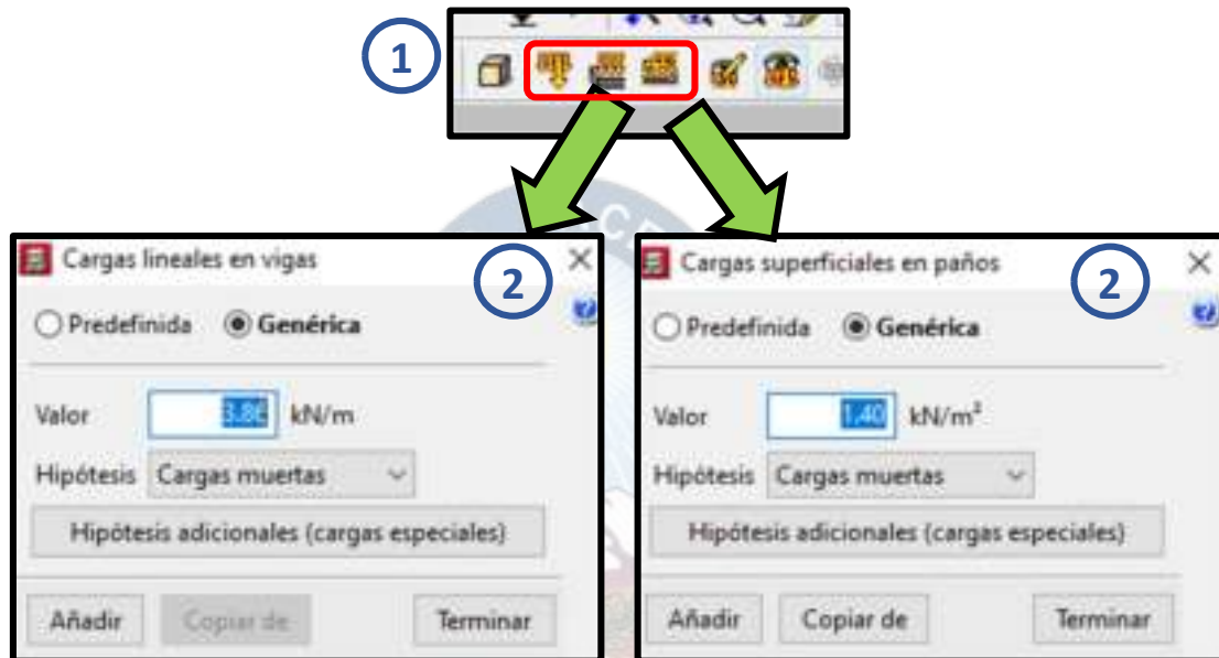
Figura 8.31. Configuración de Parámetros para Cargas Adicionales
