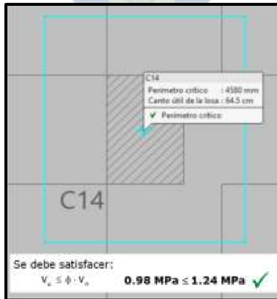
Figura 10.84. Verificación a Punzonamiento donde la columna C14 s/ NB – 1225001 Fuente: Punzonamiento. Programa CYPECAD v2025.b
