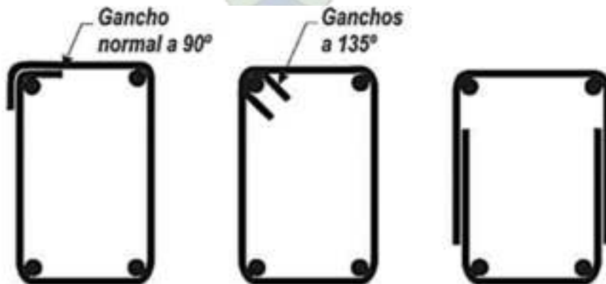
Figura 3.102. Ejemplos de conformación de estribos Fuente: Normativa Boliviana NB – 1225001, Figura 7.11.3, Pag 101
