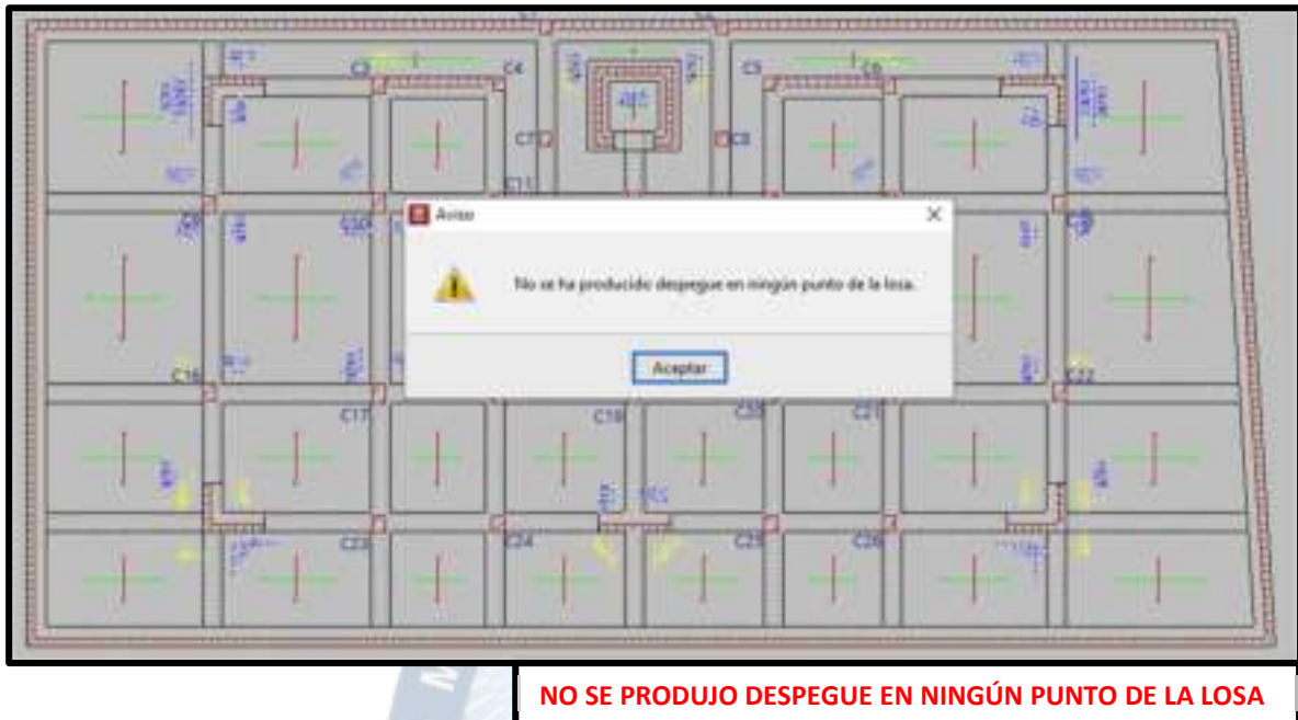
Figura 10.47. Verificación de Despegues en la losa de Cimentación s/ CBH – 87
