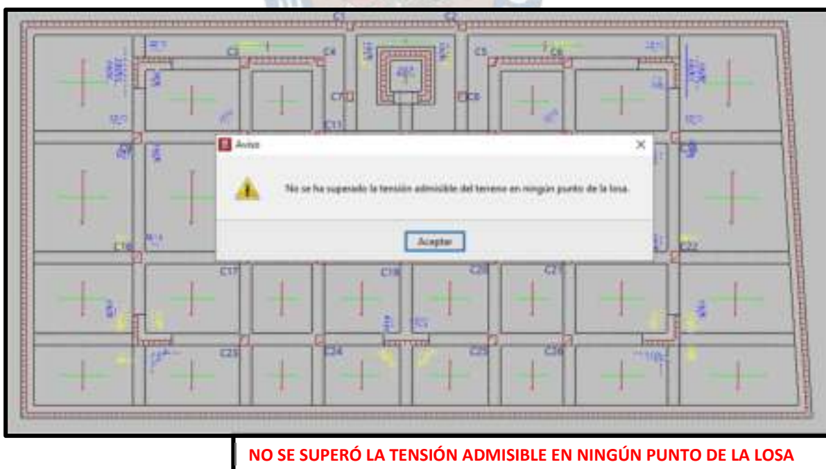
Figura 10.46. Verificación de Tensiones Excesivas en la losa de Cimentación s/ CBH – 87
