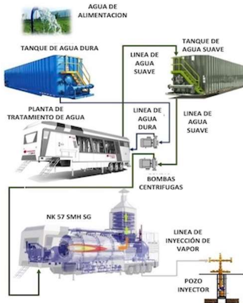
Figura 5.13 Sistema de Tratamiento del agua
