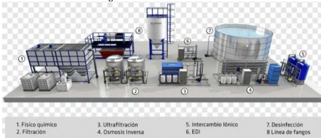
Figura 5.14 Planta de Tratamiento
