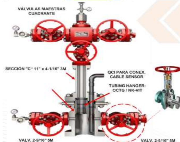
Figura 5.11 Cabezales de pozos para inyección de vapor
