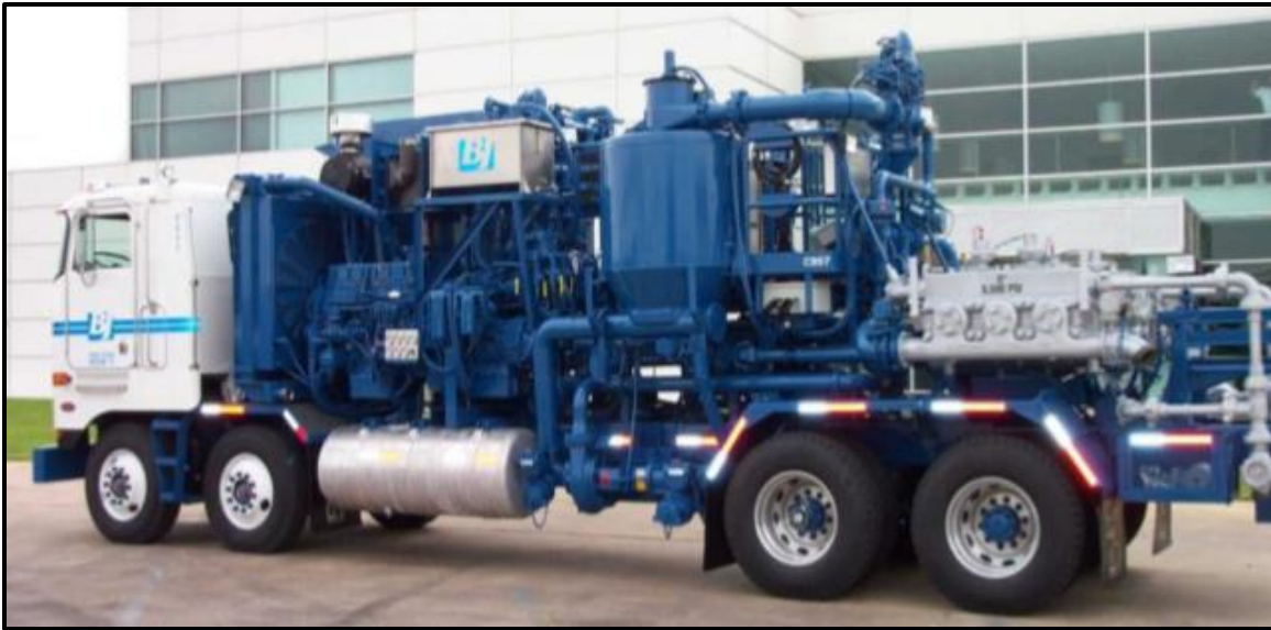
Figura 2.35. Unidad de Cementación On Shore
