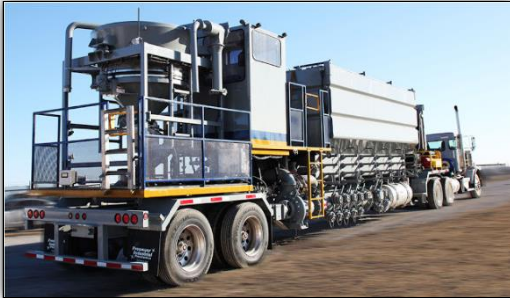
Figura 2.23 Unidad de Hidratación
