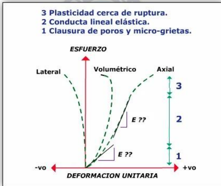
Figura 2.7 Etapas del proceso de deformación de acuerdo al esfuerzo aplicado
