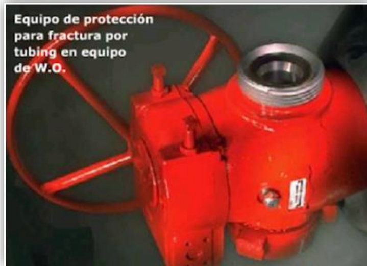
Figura 2.31 Equipo de protección de fractura por tubing en equipo W.O.
