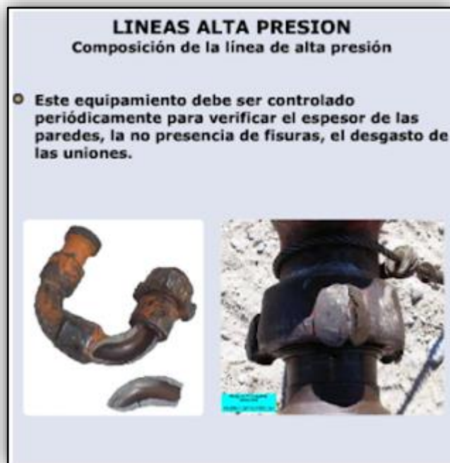
Figura 2.30 Efectos de la erosión en elementos que componen la línea de alta presión.
