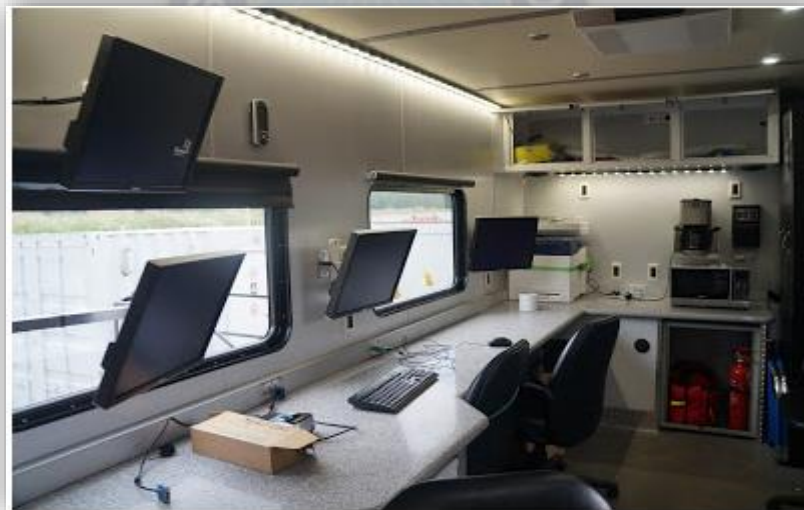
Figura 2.28 Estación de control de los FracVans
