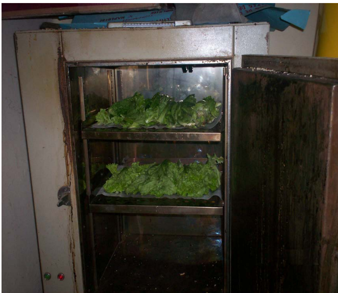
Figura 15. Determinación del porcentaje materia seca de las diferentes variedades al colocarlas en la mufla
