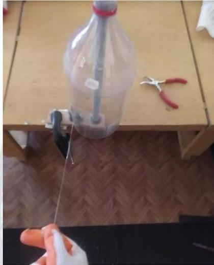
Una de las principales dificultades en este proceso fue el fileteado de hilos de 1mm de ancho, que en botellas dobladas o con muchas deformaciones por diseños de las marcas de refrescos, imposibilitaban el corte continuo y provocaban una rotura en las tiras PET.
