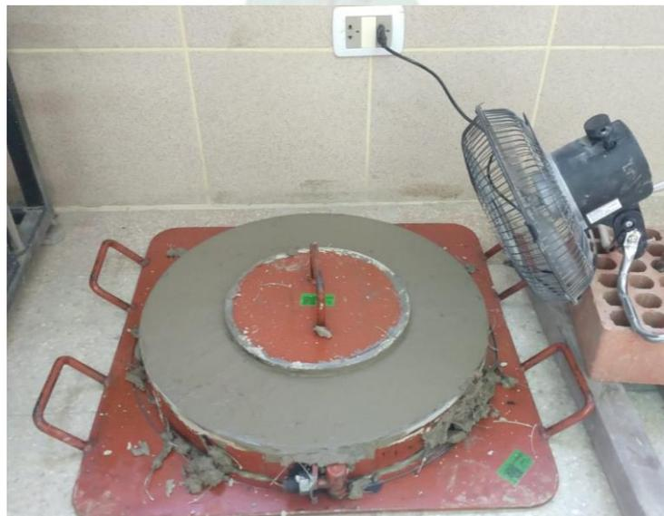
Al cabo de 24 horas, se procede a desconectar el ventilador y se realiza una identificación de las fisuras, con la medición de la longitud y ancho, figura 3.18, que se registra en planilla. Para la medición de fisuras se utilizó un microscopio digital junto al programa MicroCapture\_veh, los mismos fueron proporcionados por el ingeniero Jhadiel Villafuerte.
