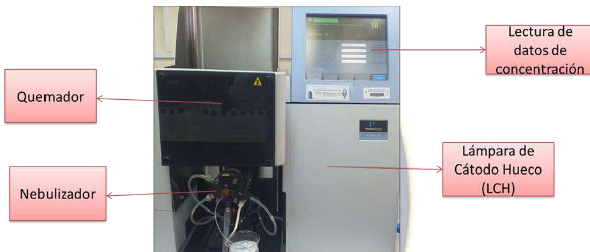
Figura 17. Espectrofotómetro de absorción atómica FAAS (Analyst 200)
