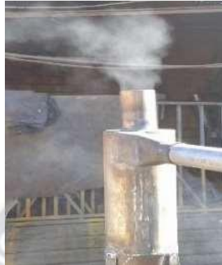
Figura 18 Vapor emitido del ciclón a partir del proceso de calcinación de yeso a escala Bench. Fuente. Elaboración propia.
