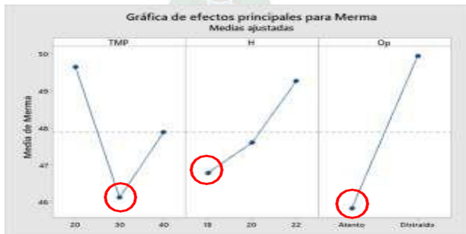
Figura 22 Análisis de niveles, para la reducción de merma de mineral. Fuente. Elaboración propia en base a MINITAB (Trial).
