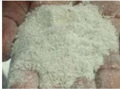
Figura 16 Muestra de mineral residual en el sector de chancado y molienda. Fuente. Elaboración propia.
