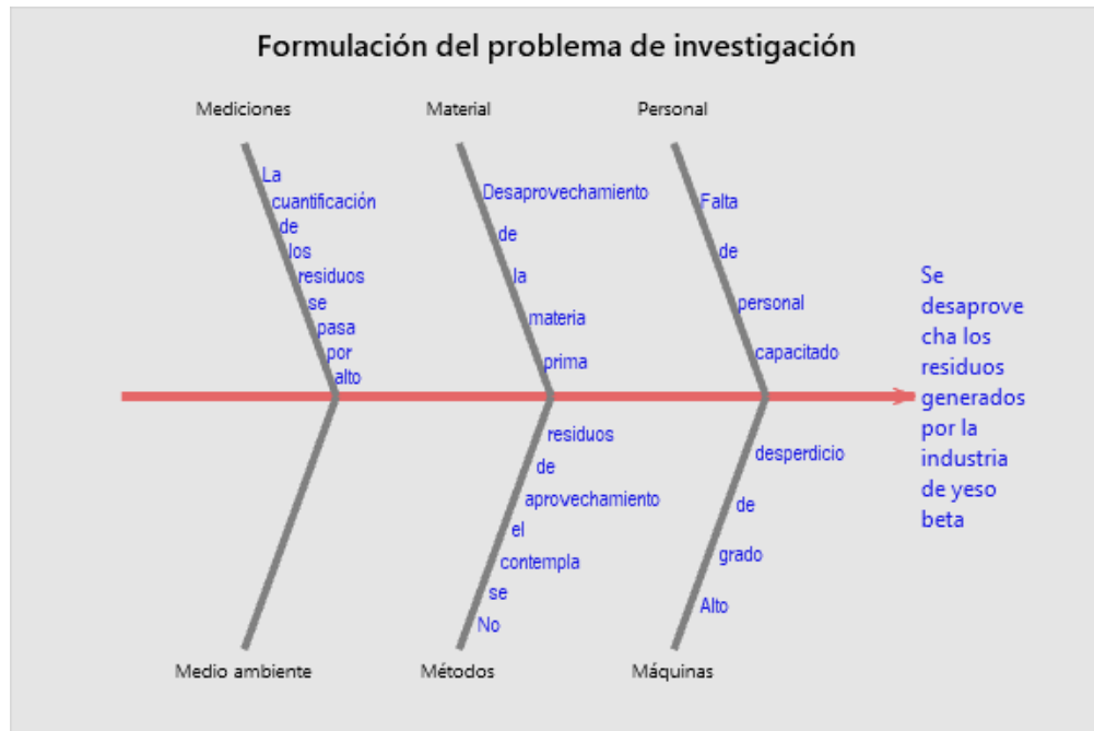
Figura 4 Diagrama de Ishikawa para presentar las causas y el efecto del problema, en base a MINITAB (TRIAL). Fuente. Elaboración propia.
