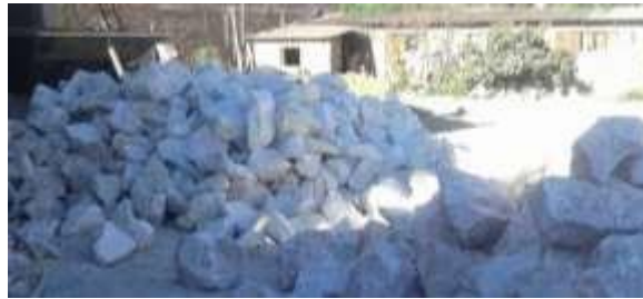
Figura 12 Materia prima acopiada, piedra de no más de 40 cm. Fuente. Elaboración propia.
