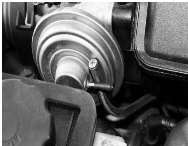
Figura 3.17: Válvula EGR de Accionamiento neumático Anulada
