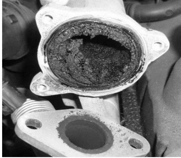
Figura 3.16: Acumulación de Carbonilla en EGR
