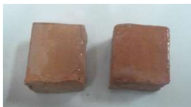
Figura 36: Material Vitriocerámico de Titanio
