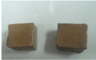
Figura 32: Material Vitriocerámico de Litio
