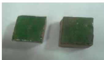
Figura 38: Material Vitrioceramico de Cromo
