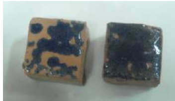
Figura 37: Material Vitrioceramico de Cobalto
