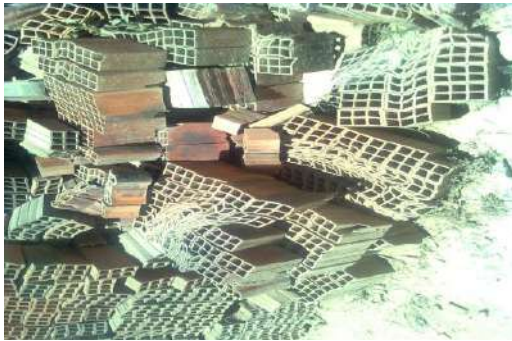
Figura 28: Ladrillos perdidos por quemada
