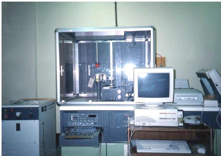
**Ilustración 29** Equipo de Rayos X de tipo Rigaku
