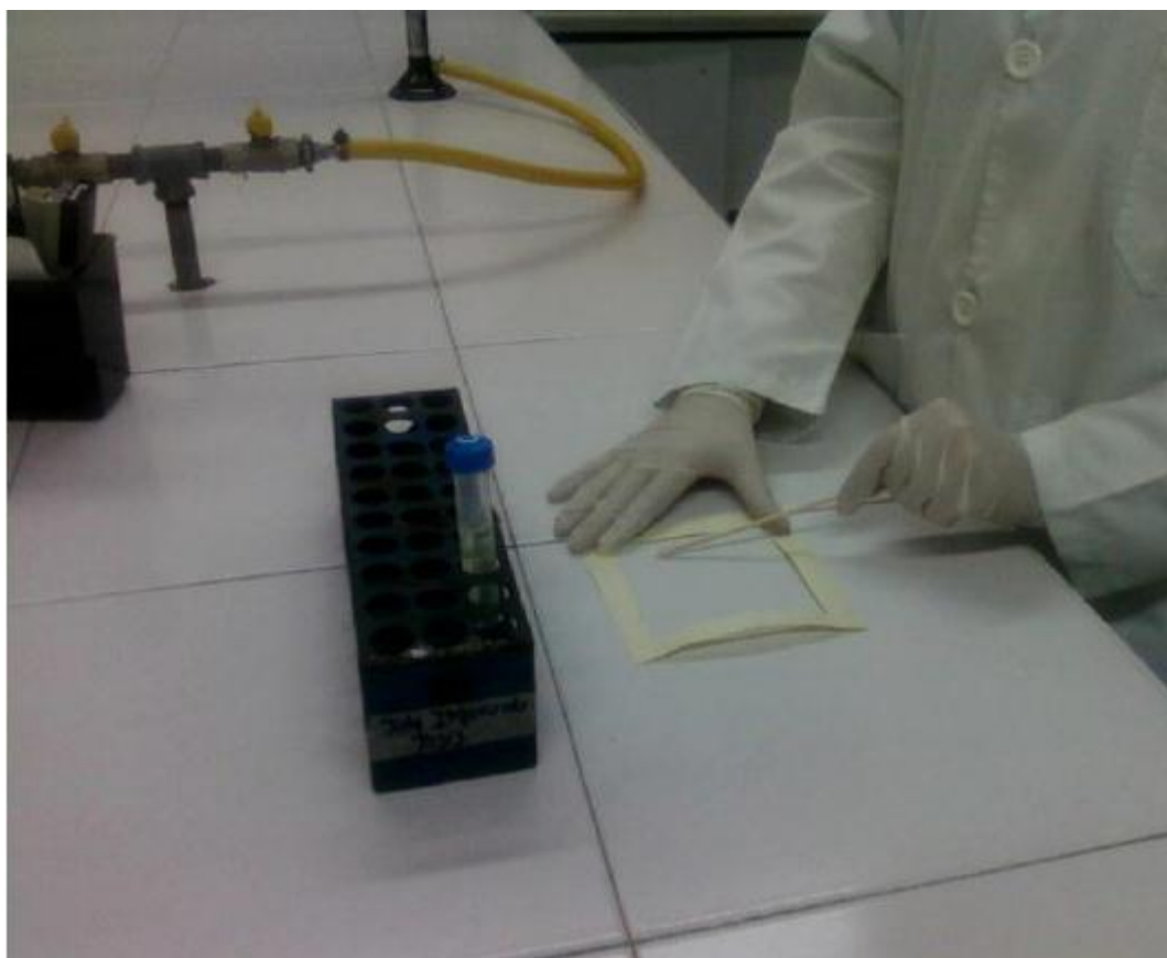
Figura No. 1 FORMA DE MUESTREO EN LAS SUPERFICIES REALIZADAS
