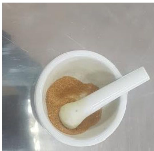
Trituración de la levadura seca
