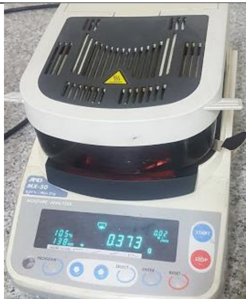
Determinación de la humedad en la muestra
