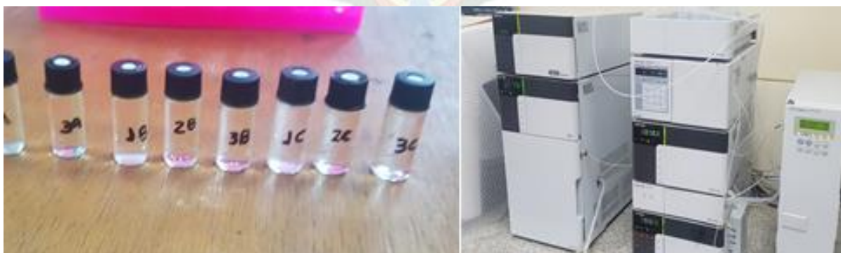
Figura 23 Filtración de las muestras y lectura en HPLC Fuente Propia
