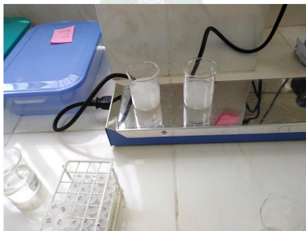
Figura 32 Determinación de la curva cinética en un DAM sintético Fuente propia
