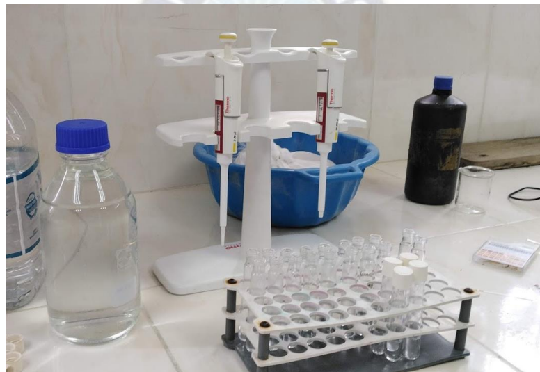
Figura 34 Preparación de muestras para lectura de metales pesados Fuente propia
