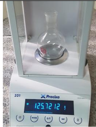
Determinación del peso del balón de extracción
