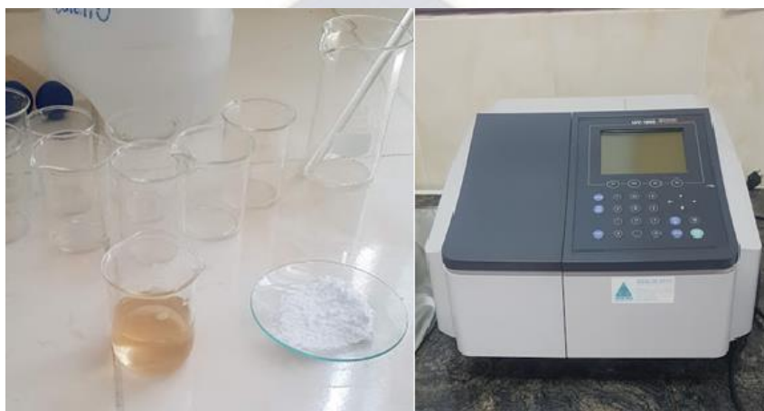
Figura 22 Neutralización de la muestra y lectura en espectrofotómetro UV Fuente propia
