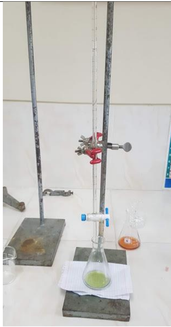
Determinación DQO en el DAM de Milluri
