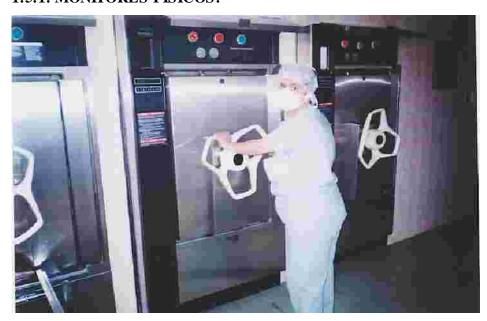
Son elementos incorporados al esterilizador que permit visualizar si el equipo ha alcanzado los parámetros exigidos en el proceso. Estos elementos termómetros, barómetros de presión, censores de carga, válvula y sistemas de registro entre otros. Deben ser registrados periódicam or personal calificado.
