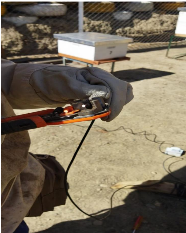
Foto 6. Pelado de cable con alicate pelacables
