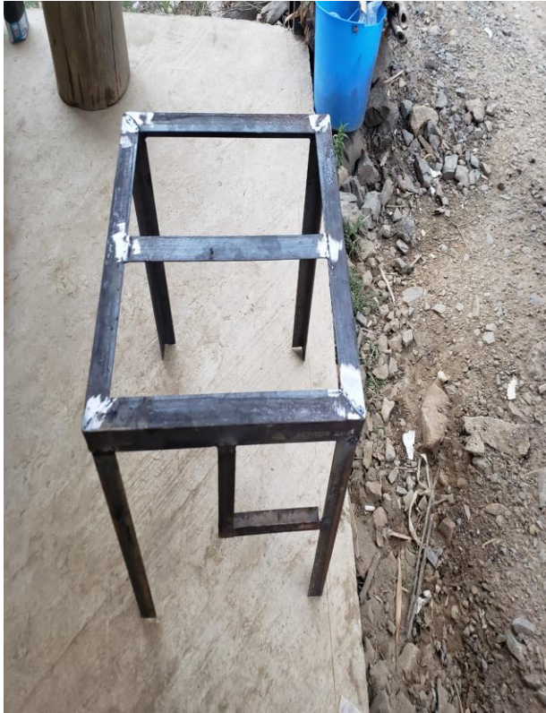
Foto 27. Pedestal recién soldado
