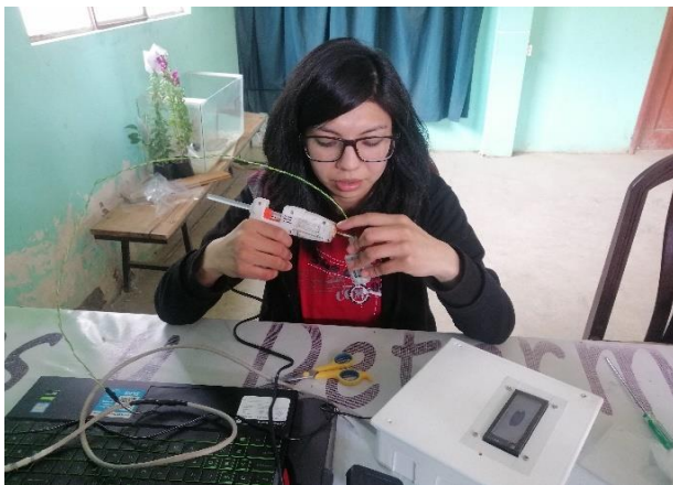
Foto 25. Sellado con silicona la parte abierta de la rejilla donde se encuentra el sensor
