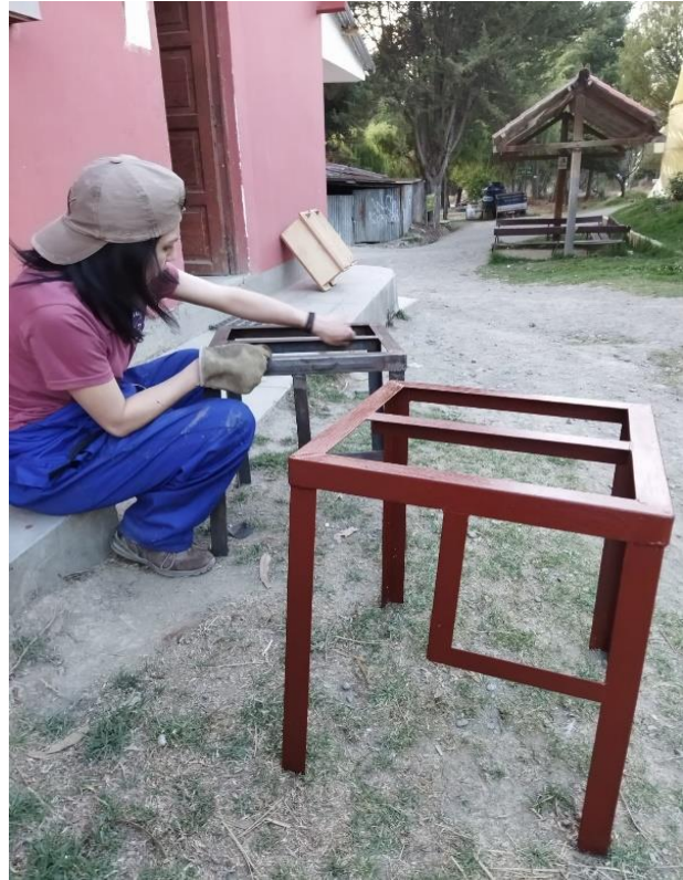
Foto 28. Lijado y pintado de pedestal con pintura anticorrosiva
