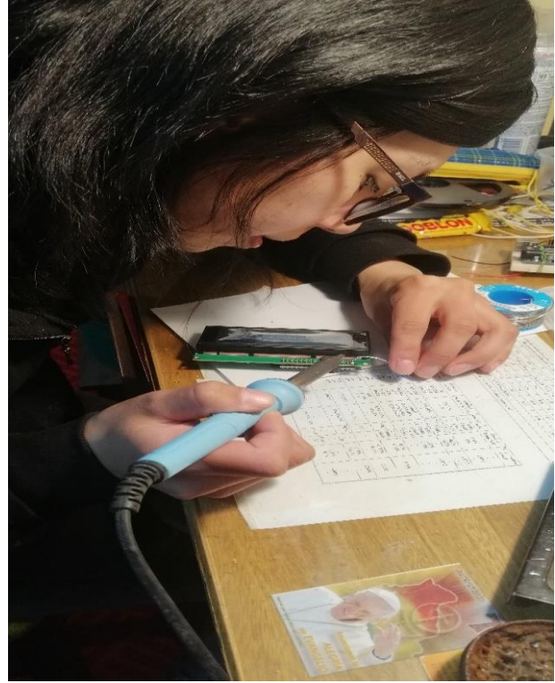
Foto 20. Soldadura de componentes con estaño
