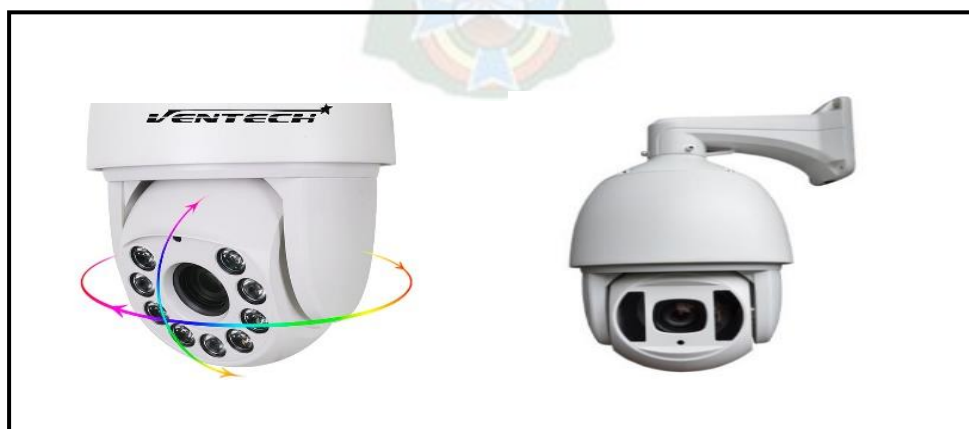
Figura 17: Modelo de Cámaras PTZ domo Fuente: https://es.wikipedia.org/wiki/camara
