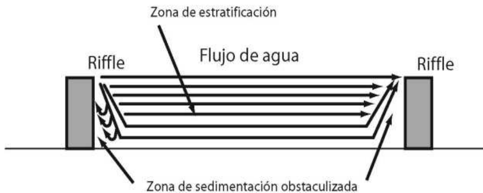
Figura 20 Esquema de la zona de estratificación y de la sedimentación obstaculizada, reproducida del internet
