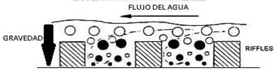
Figura 22 Esquema de la estratificación, reproducida del internet
