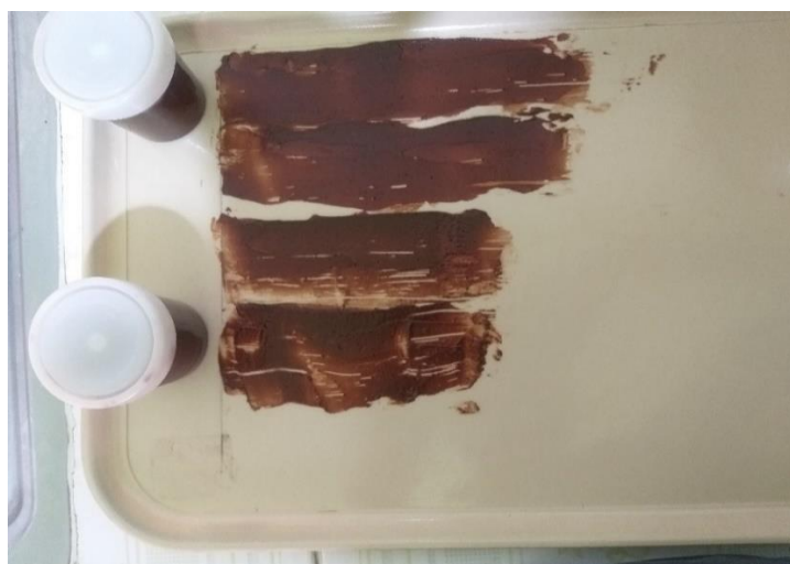
Figura 18. Proceso para determinar la capacidad de extensión del producto
