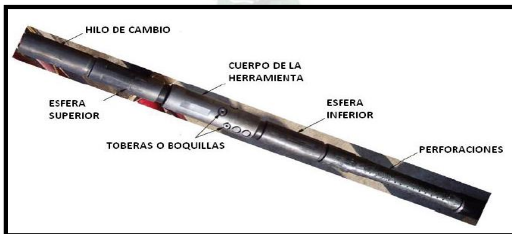
Figura 2.26. Sección de una herramienta para pozo tratamiento con HJAF
