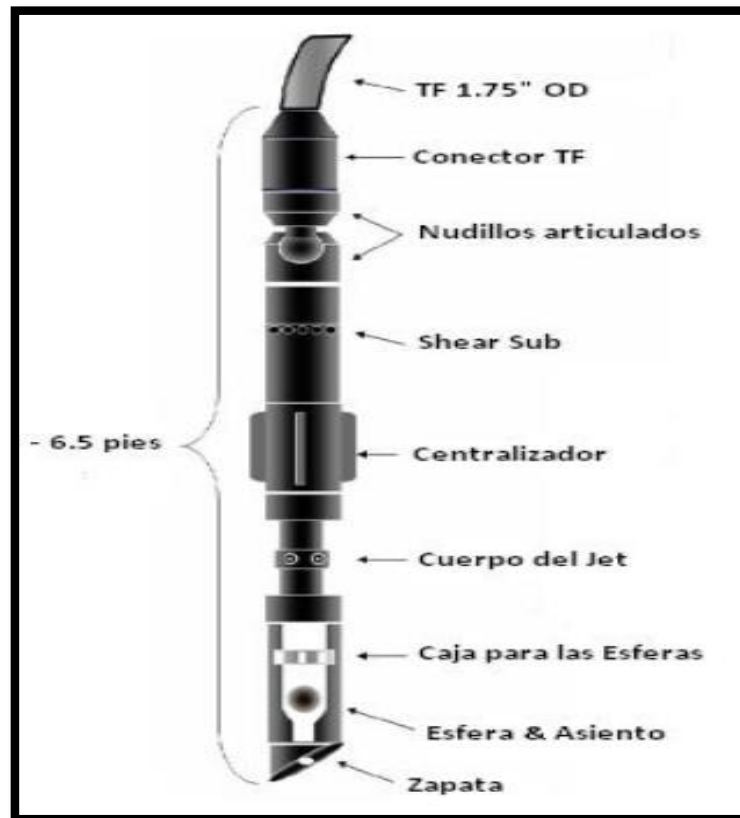
Figura 2.27. Equipo de fondo del método HPAP con PPD
