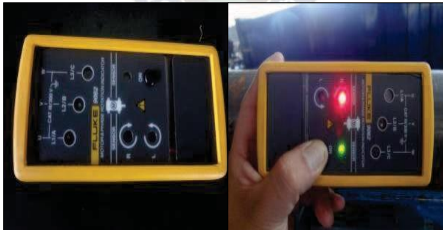
Figura 2.34: Verificación del giro del motor
