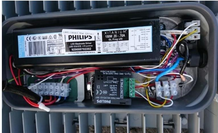
Figura 91 Conexión interior luminaria LED (Philips)
