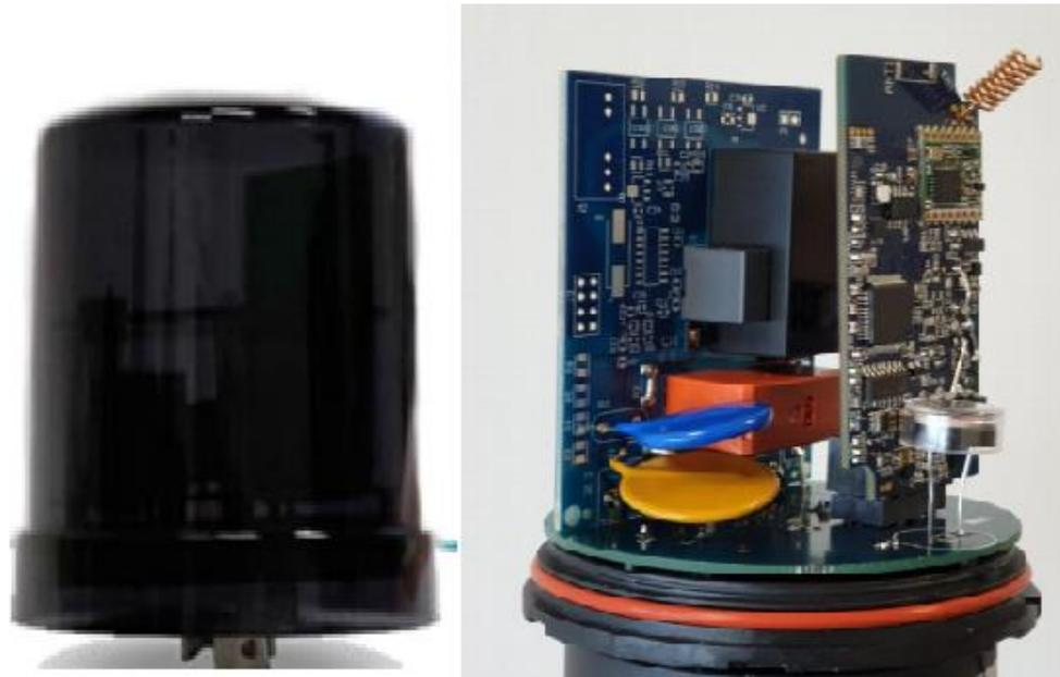
Figura 96 Fotocontrol NEMA 7 por exterior e interior(LUXIOT)
