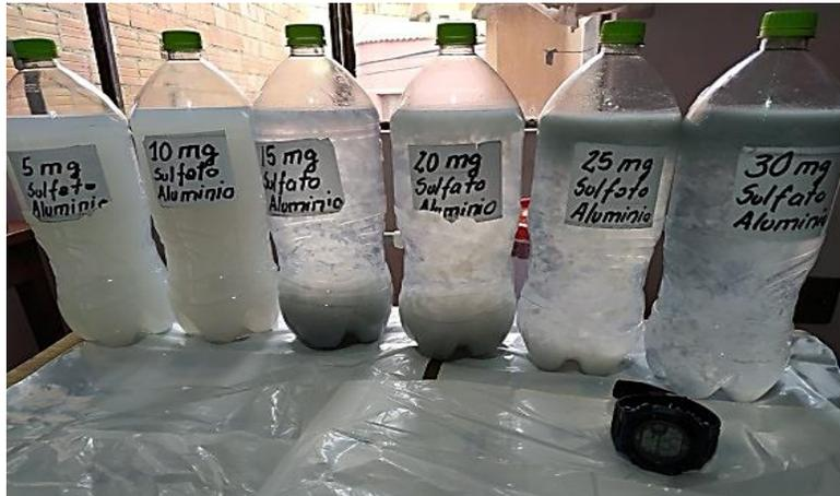
Obtenido el dato de la mejor dosis, se preparó 12 litros de agua gris, vertiéndose al mezclador manual para poder verter la dosis y realizar la agitación rápida y lenta, terminada esto se dejó sedimentar para que las aguas clarificadas pasen al tanque recolector de agua clarificada, y mediante llaves de paso manipular el paso hacia los filtros y obtener un agua tratada.
