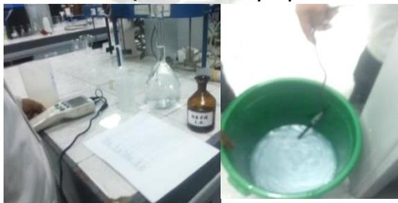
Corregido el pH, se realizó el ensayo de jarras en el equipo, así como muestra la (Figura 6.30), cumpliendo el mismo procedimiento visto, en el primer ensayo en laboratorio.
