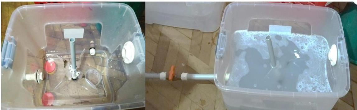
Se realizó la agitación manual con el brazo, cumpliendo velocidades de mezclado y de sedimentación según:
