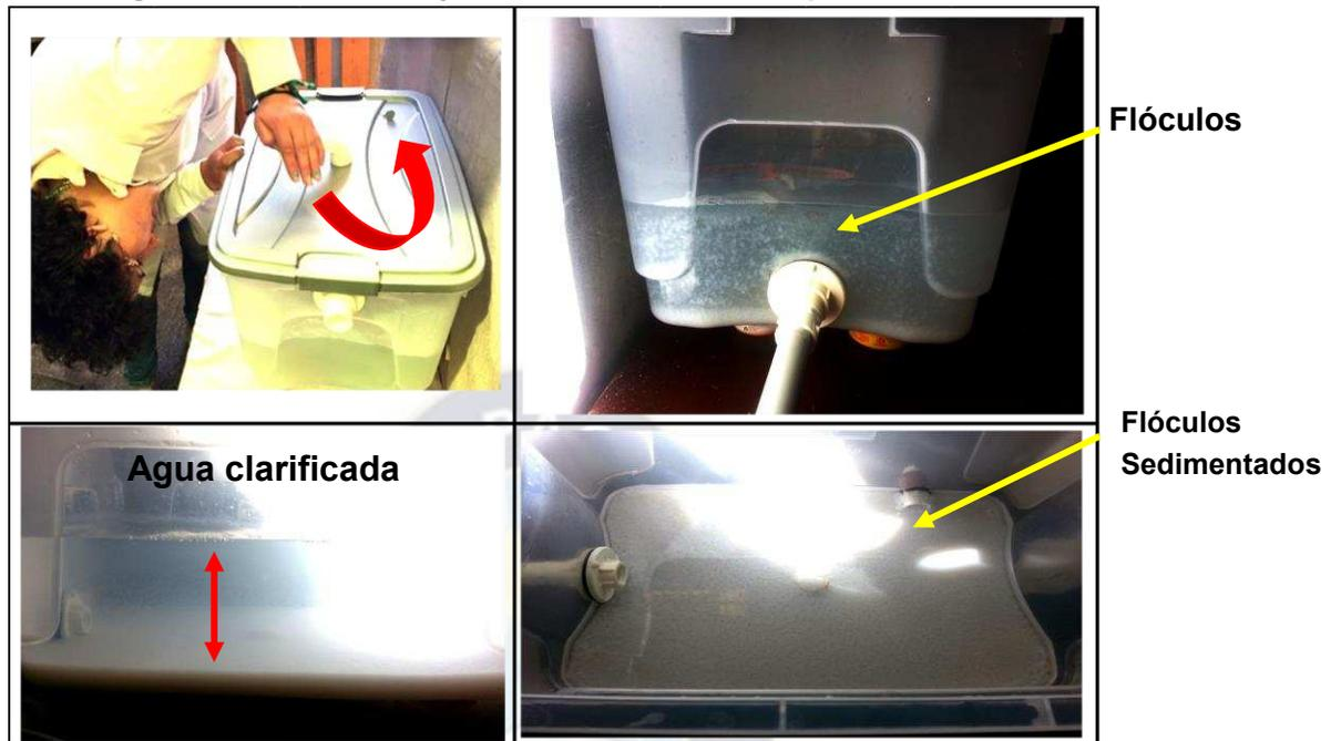
4.-Pasado 1 hora se abrió las llaves del sistema, y por gravedad el agua más clarificada paso al tanque recolector de aguas clarificadas, seguidamente se abrió las llaves de los filtros, para poder recolectar muestras de agua tratada, para su caracterización en laboratorio, así como muestra la (Figura 6.47).
