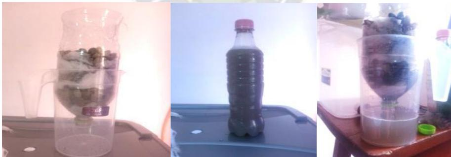
Simultáneamente se preparó la misma muestra en una jarra de 1 litro, de acuerdo a videos del internet y bibliografía investigada, donde se experimentó el proceso de coagulación, floculación y sedimentación, agregando sulfato de aluminio en polvo (piedra alumbre) a la jarra, agitándose con una varilla de plástico después de unos segundos se dejó sedimentar y observar la reacción.
