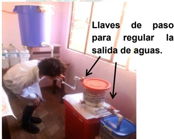
Figura 6.25 Filtración de agua clarificadas con carbón activado
