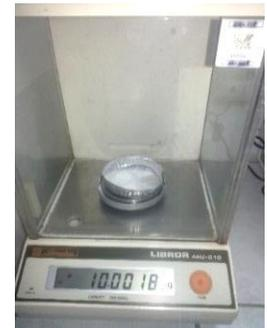
**Figura 6.27 Preparación de la dosificación de coagulante sulfato de aluminio granulado a una concentración de 1 %**
