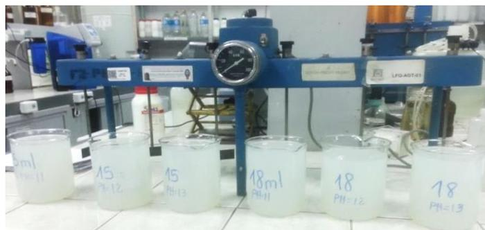
Este ensayo de jarras se realizó bajo las mismas condiciones de operación que los ensayos anteriores y al finalizar el tiempo requerido para la sedimentación se procedió a medir turbidez y pH.
