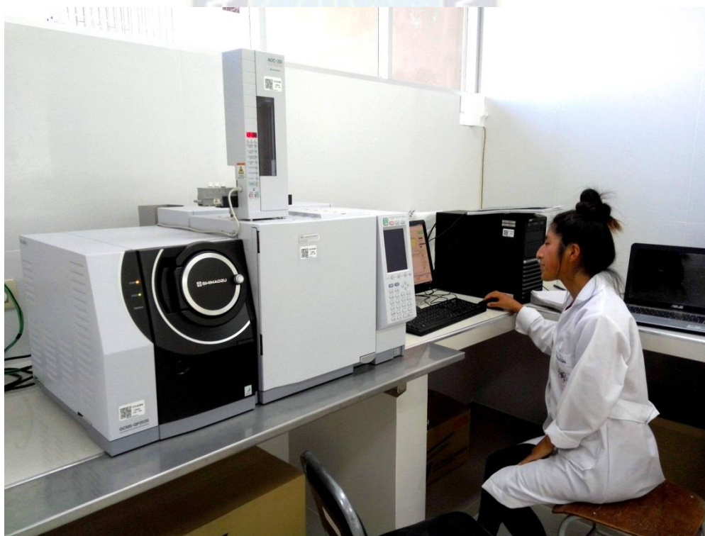
Figure 3.10: Equipo CG-MS SHIMADZU QP2020 utilizado en la determinación del principio activo
